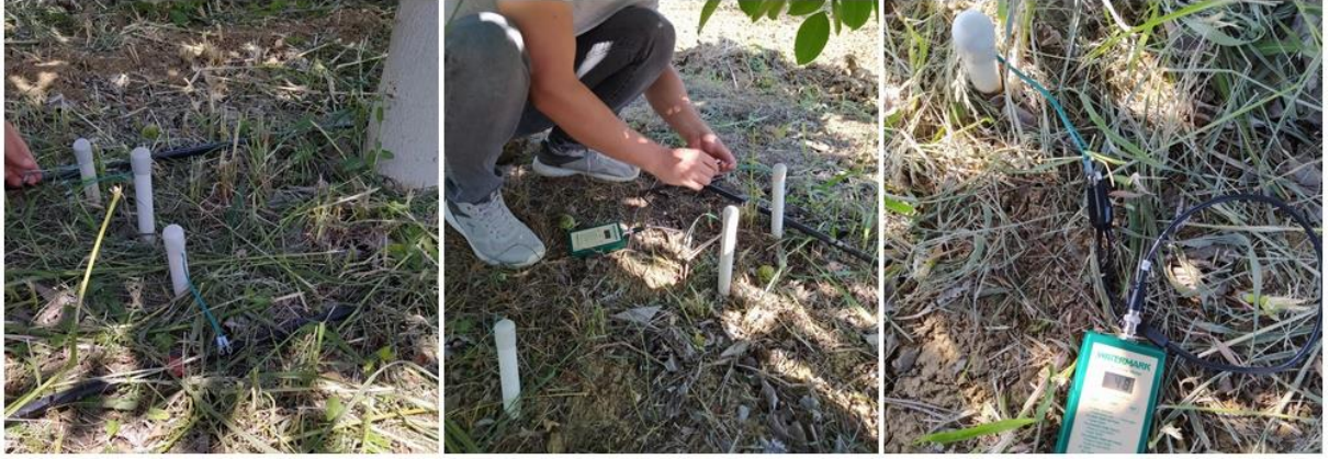
Şekil 3.12. Deneme kullanılan watermark toprak nem sensörleri
