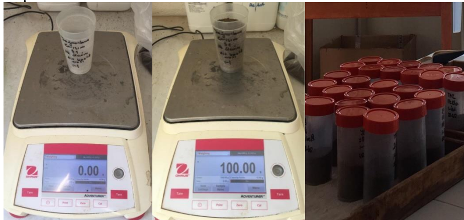
Şekil 2.14. Elenmiş toprak örneğinin (100 g) satüre hale getirilmesi ve bekletilmesi
