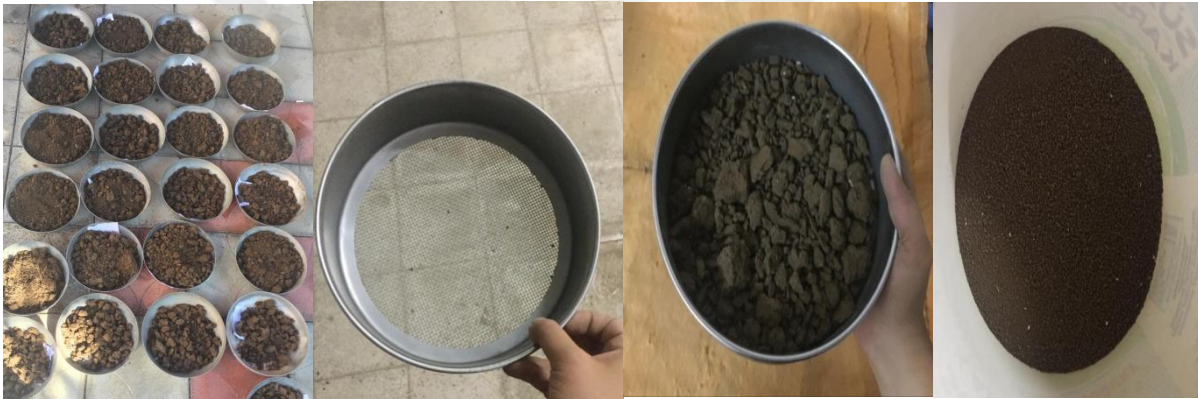
Şekil 2.13. Toprak örneklerinin kurutulmuş elenme süreci
