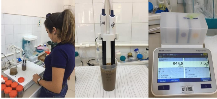
Şekil 2.15. EC ölçer ile elektriksel iletkenlik değerlerinin saptanması
