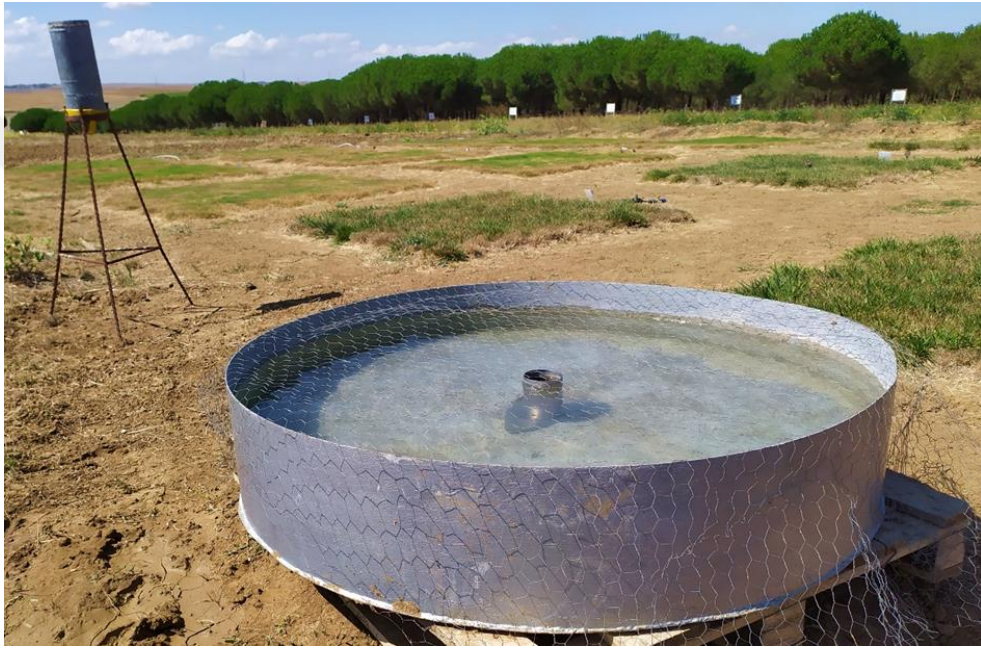
Şekil 2.5. A sınıfı buharlaşma kabı ve pülvimetre
