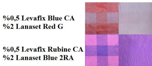
Şekil 4.28: İşletme ölçekli denemelerde üretilen kumaş numunelerinin laboratuvarında reaktif ve 1:2 metal kompleks boyarmaddelerle tek banyolu boyanmasına ilişkin fotoğraflar (1 nolu kumaşlar solda, 2 nolu kumaşlar sağda)
