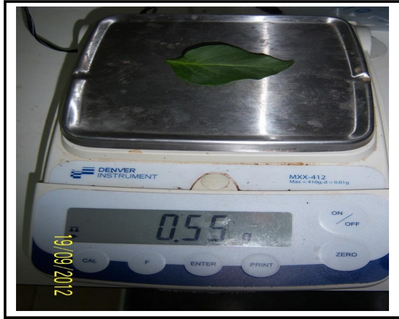
Şekil 3.12. Tek yaprakların ağırlıklarının hassas terazide ölçülmesi
