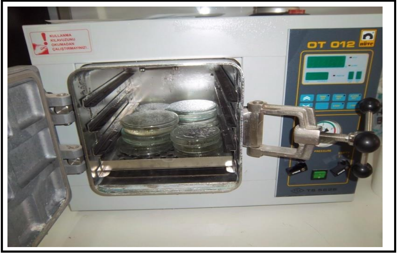
Şekil 3.8. Biber bitkisinin yapraklarından 17 mm çapında alınan disklerin bulunduğu petri kaplarının otoklavda 100 °C’de 10 dakika bekletilmesi
