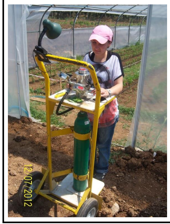
Şekil.3.4. Scholander basınç odası ile gün ortası yaprak su potansiyeli ölçümü
