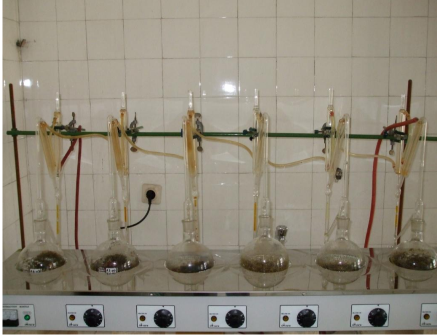
Şekil 3.8. Su distilasyonu yöntemi ile uçucu yağın elde edildiği Clevenger Aparatı
