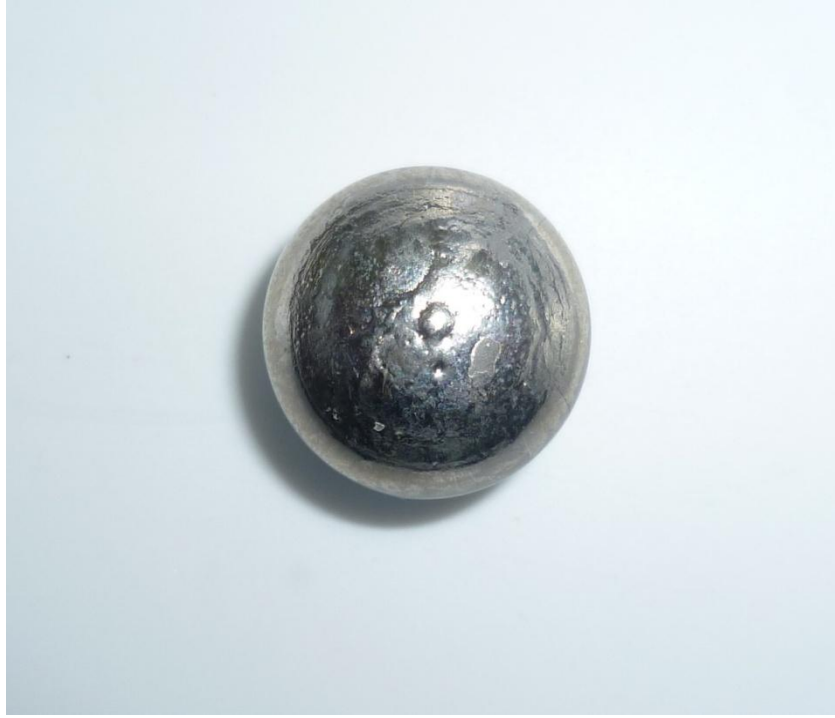
Şekil 3.4. Ark eritme yöntemiyle üretilmiş 3 gram \text{Fe}_{36}\text{Co}_{36}\text{B}_{19.2}\text{Si}_{4.8}\text{Mo}_2\text{W}_2 alaşımı
