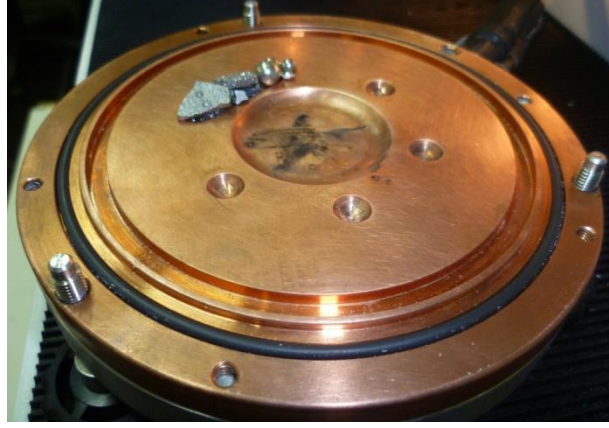
Şekil 3.2. Elementlerin yerleştirildiği su ile soğutulan bakır pota
