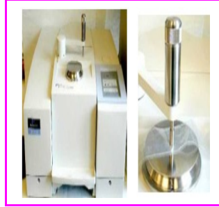
Şekil 3.3. Denemelerde kullanılan FT-IR cihazı ve ATR düzeneği
