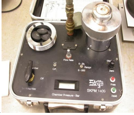
Şekil 3.1.2.2.1. Çanta tipi dijital ve arazi tipi Scholander basınç odası
