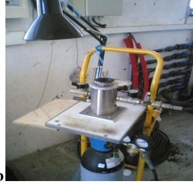
Şekil 3.1.2.2.1. Çanta tipi dijital ve arazi tipi Scholander basınç odası
