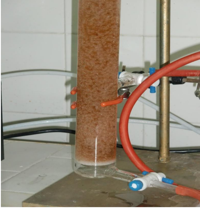
Şekil 3.6 Ozonlama esnasında kabarcıkların görünümü
