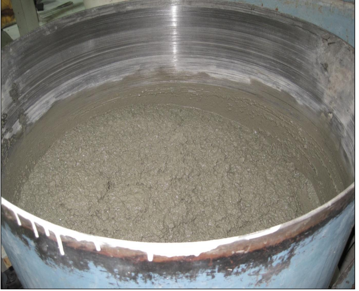
Şekil 3.9. Karışım Suyu Eklendikten Sonraki Durum
