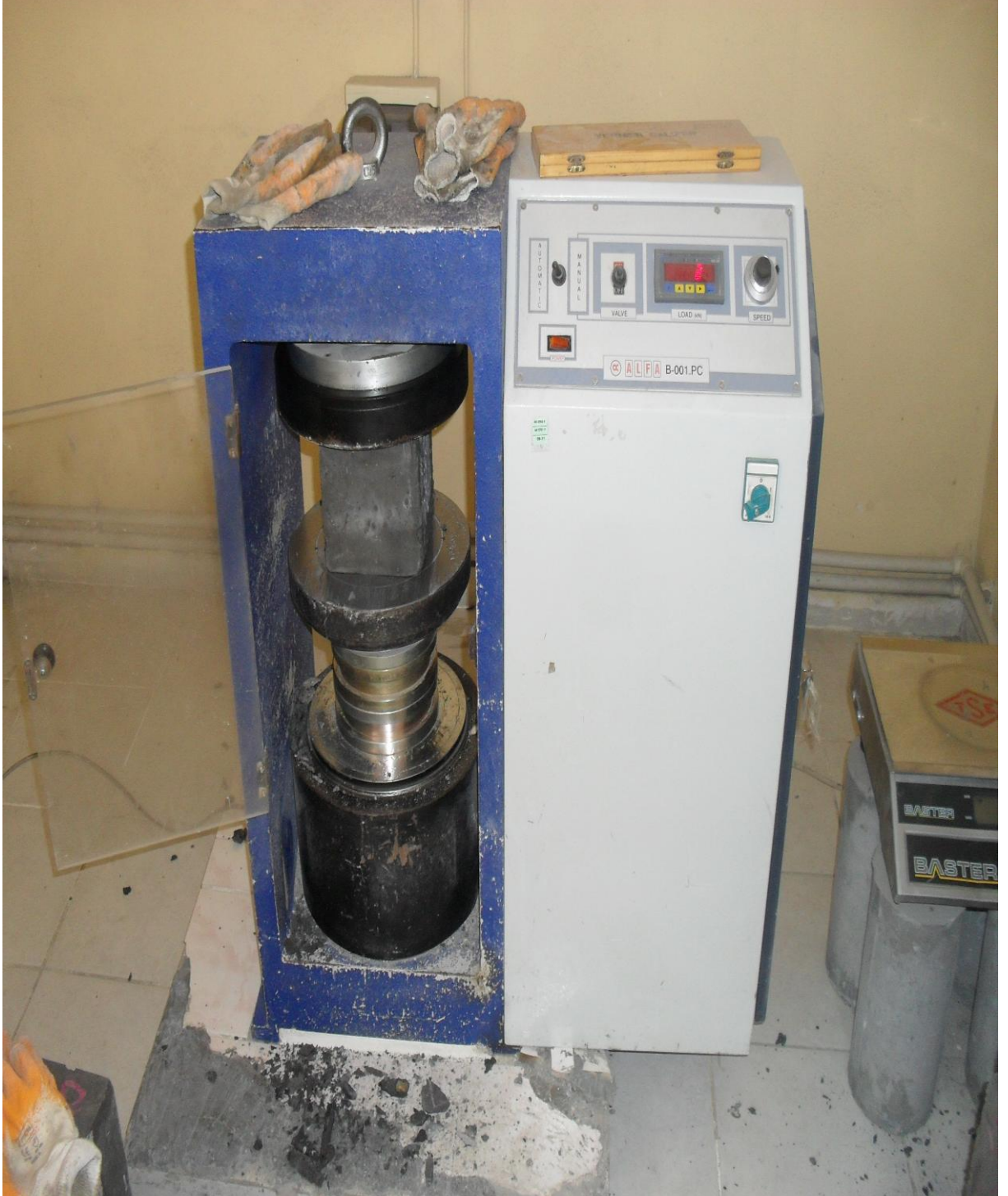
Şekil 3.12. Hafif Beton Basınç Dayanımı Deneyi
