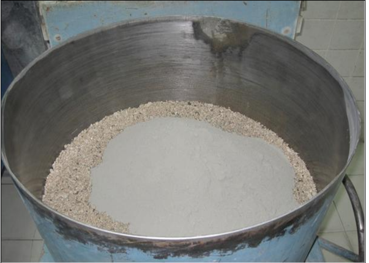
Şekil 3.8. Karışım Suyu Eklenmeden Önceki Durum
