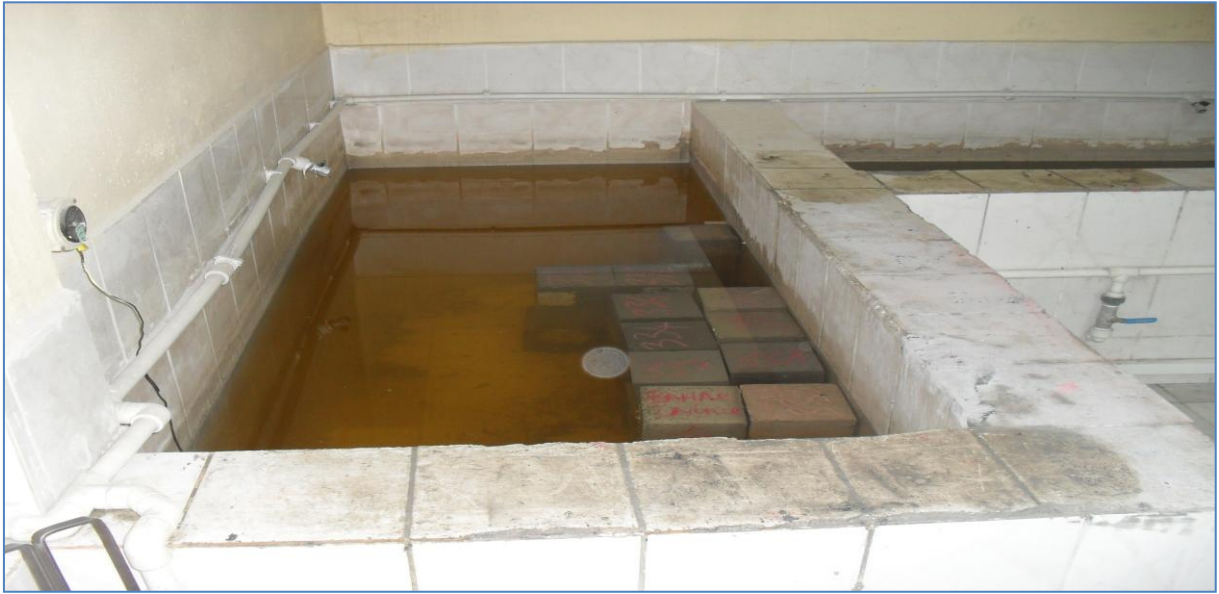
Őekil 3.11. Su Emme Oranı Tayini İçin 24 Saat Suda Bekletilen Numuneler
