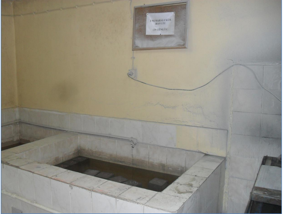
Şekil 3.10. Numunelerin Kür Havuzunda Bekletilmesi
