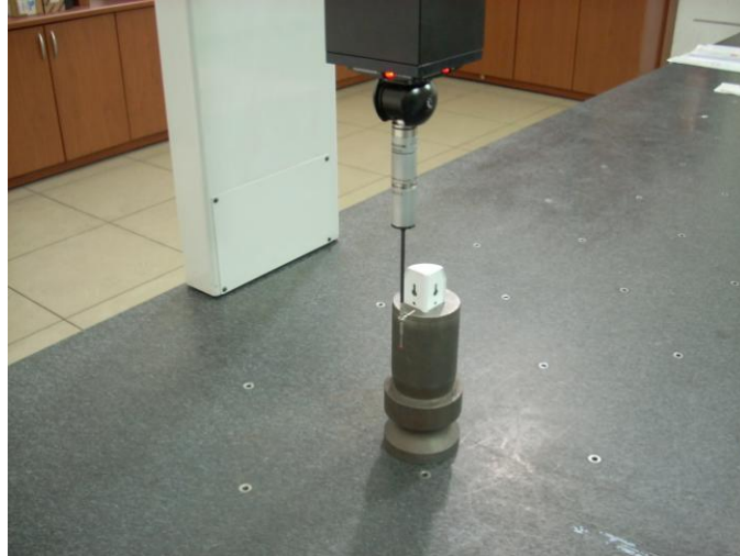
Şekil 4.1. ABS'nin koordinat ölçümü
