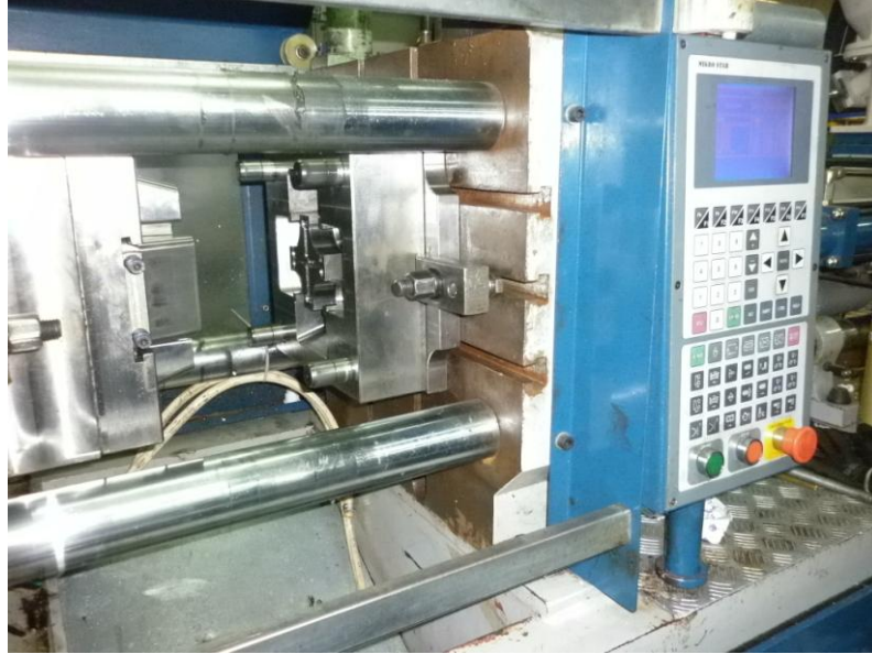
Şekil 3.18. Enjeksiyon tezgahına bağlanmış kalıp seti
