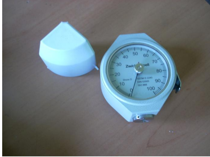
Şekil 4.4. Shoremetre sertlik ölçüm cihazı
