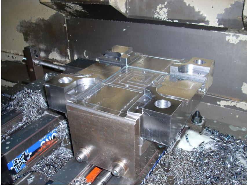
Şekil 3.15. Kalıp erkek plakasının tezgahda üretimi
