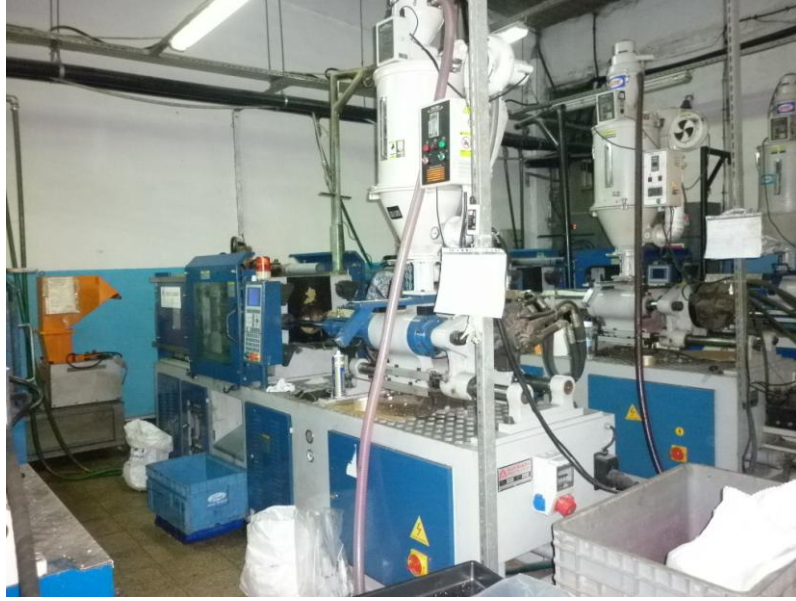
Şekil 3.16. Enjeksiyon işleminin gerçekleştirildiği plastik enjeksiyon tezgahı
