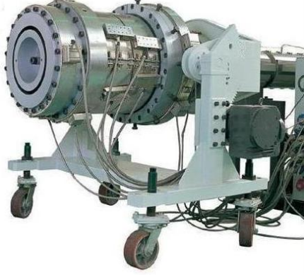
Şekil 1.4. Komple boru ekstruder kafası ve ekstüder makinesine bağlantısı (Anonim 3 2007)
