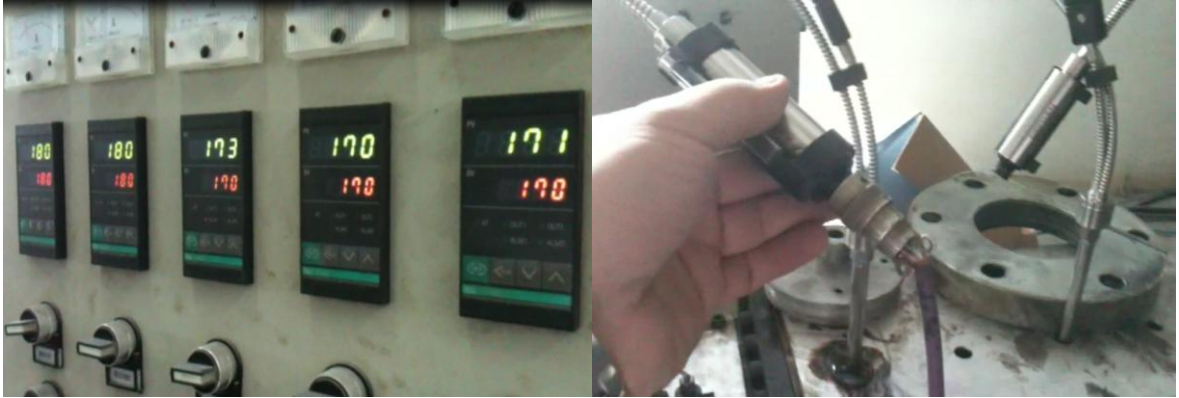
Şekil 3.15. Ekstrüder kalıbının sıcaklık ve basınç kontrol ünitesi ve basınç sensöründen basınç ve sıcaklık değerlerinin alınması
