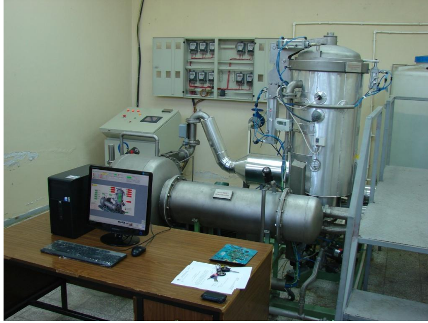
Şekil 3.23 Bobin kurutma deney düzeneğinin genel görünümü
