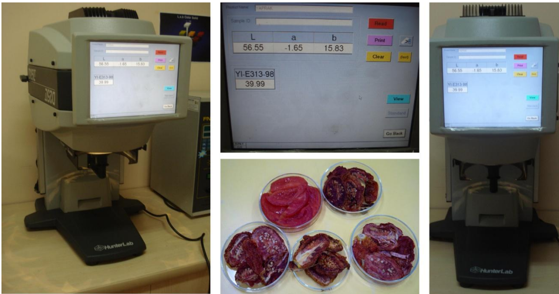
Şekil 3.7. Renk ölçümlerinde kullanılan cihaz ve kurutulmuş domates örnekleri
