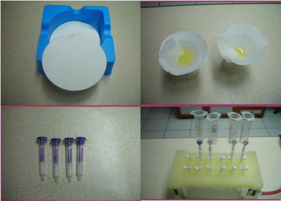
Şekil 3.5. Cam mikrofiber filtre (A), örneklerin filtreden süzülmesi (B), hızlı kolon (C) ve örneklerin hızlı kolondan geçirilmesi (D)
