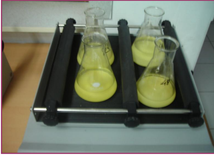
Şekil 3.3. Örneklerin çalkalayıcıda çalkalanması
