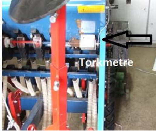
Şekil 3.9 Ekim makinası üzerinde torkmetrenin yerleşimi
