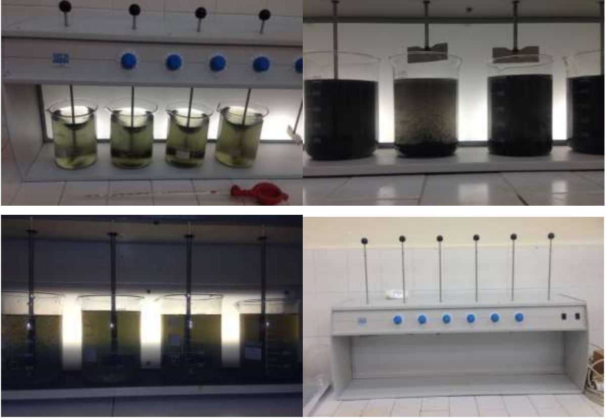
Şekil 7.2. Jar test deneylerinin yapıldığı düzenek ve çalışmalardan örnekler.
