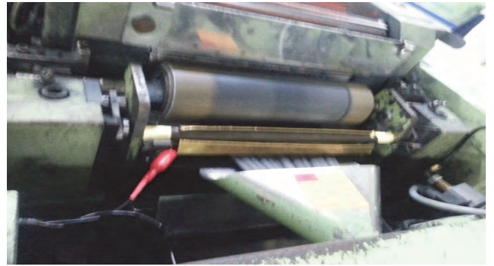
Şekil 2. Statik elektriklenme ölçüm düzeneği
