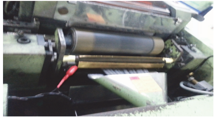
Şekil 2. Statik elektriklenme ölçüm düzeneği
