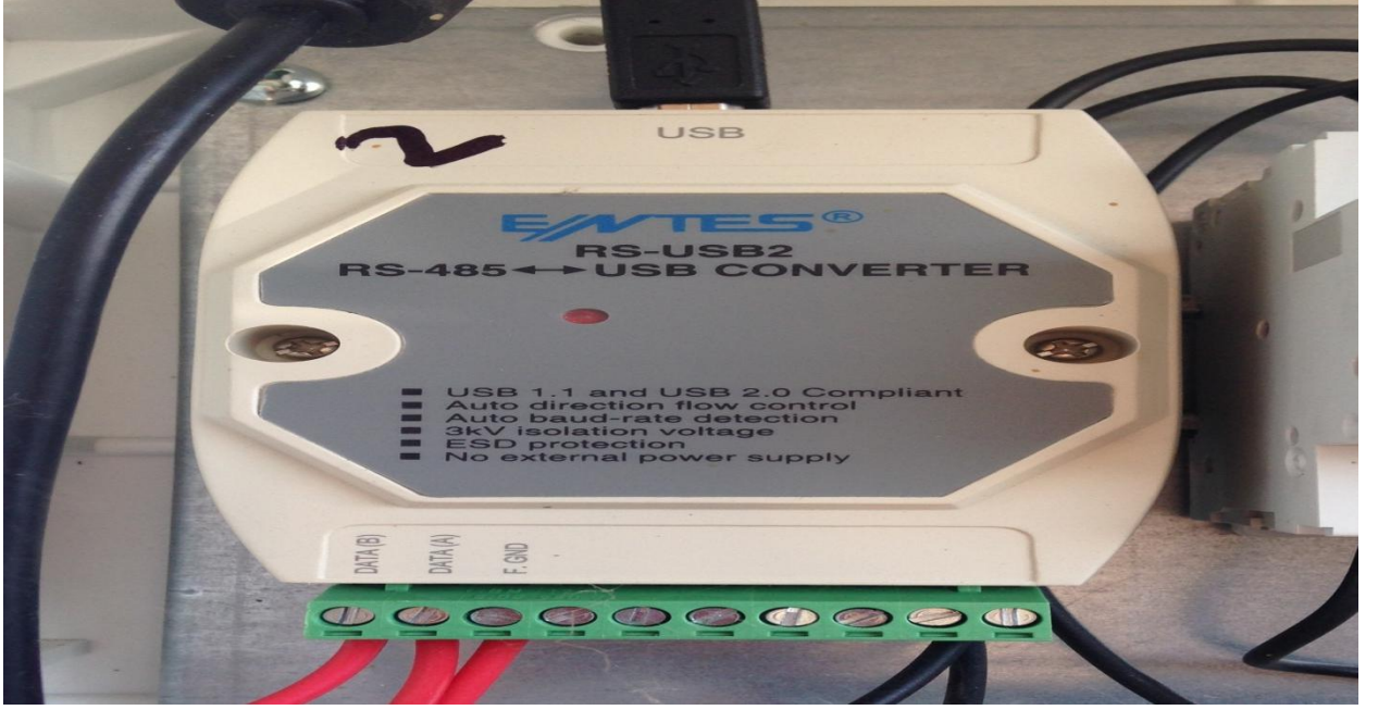
Şekil 3.4. RS485 model çevirici
