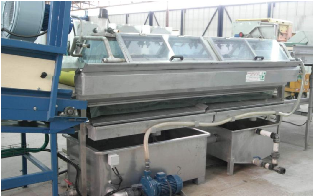
Şekil 2.3. Meyve ve sebzeler için sıcak su ile fırçalayarak temizleme uygulama teknolojisi dördüncü kuşak makinesi
