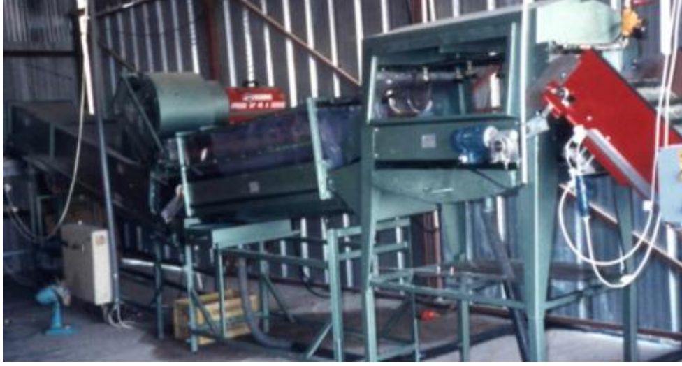
Şekil 2.1. Meyve ve sebzeler için sıcak su ile fırçalayarak temizleme uygulama teknolojisi ikinci kuşak makinesi
