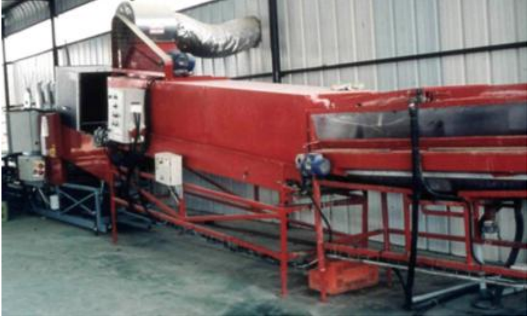
Şekil 2.2. Meyve ve sebzeler için sıcak su ile fırçalayarak temizleme uygulama teknolojisi üçüncü kuşak makinesi
