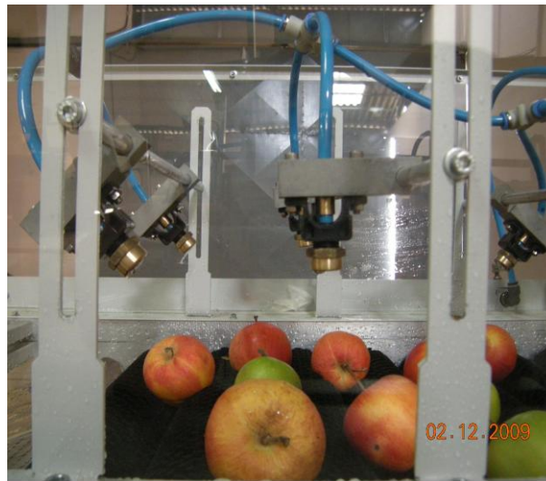
Şekil 3.13. Yıkama ünitesindeki püskürtme memeleri konumu ve basınç hattı
