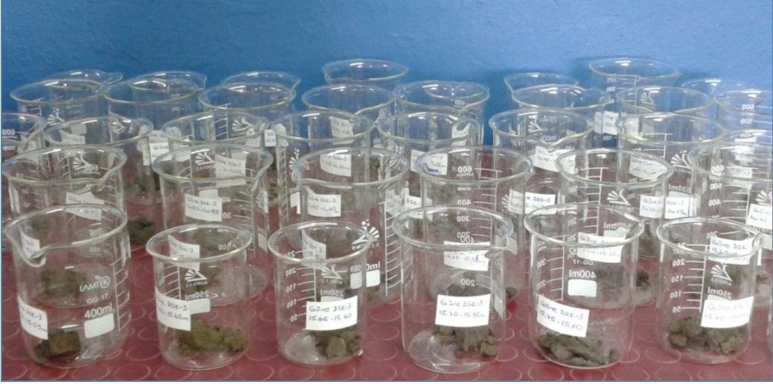
Şekil 5. 2: Laboratuvar çalışmalarında granülometrik analiz ile foraminiferlerin kilden arındırılması
