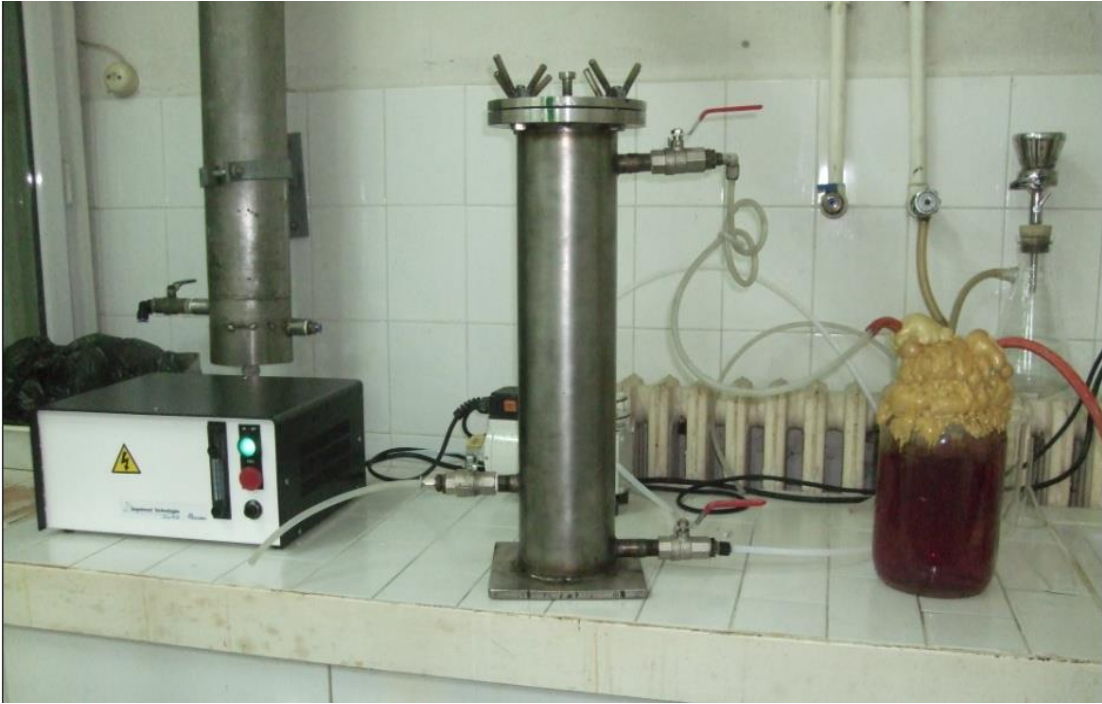
Şekil 4.6. - Ozonlama Sistemi Gaz Yıkama Şişeleri
