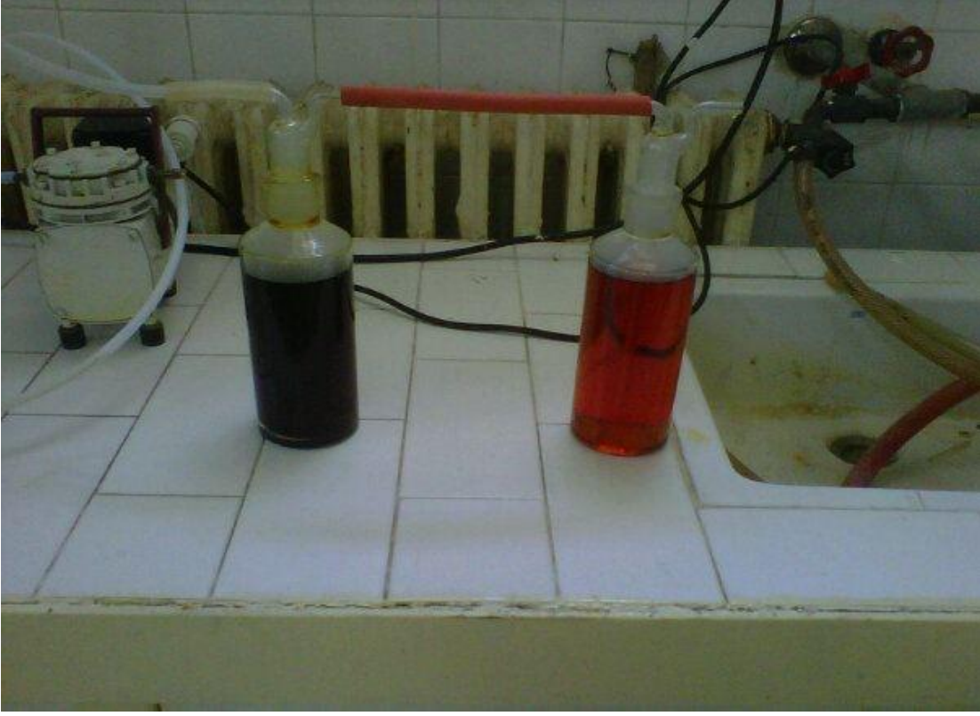
Şekil 4.6. - Ozonlama Sistemi Gaz Yıkama Şişeleri
