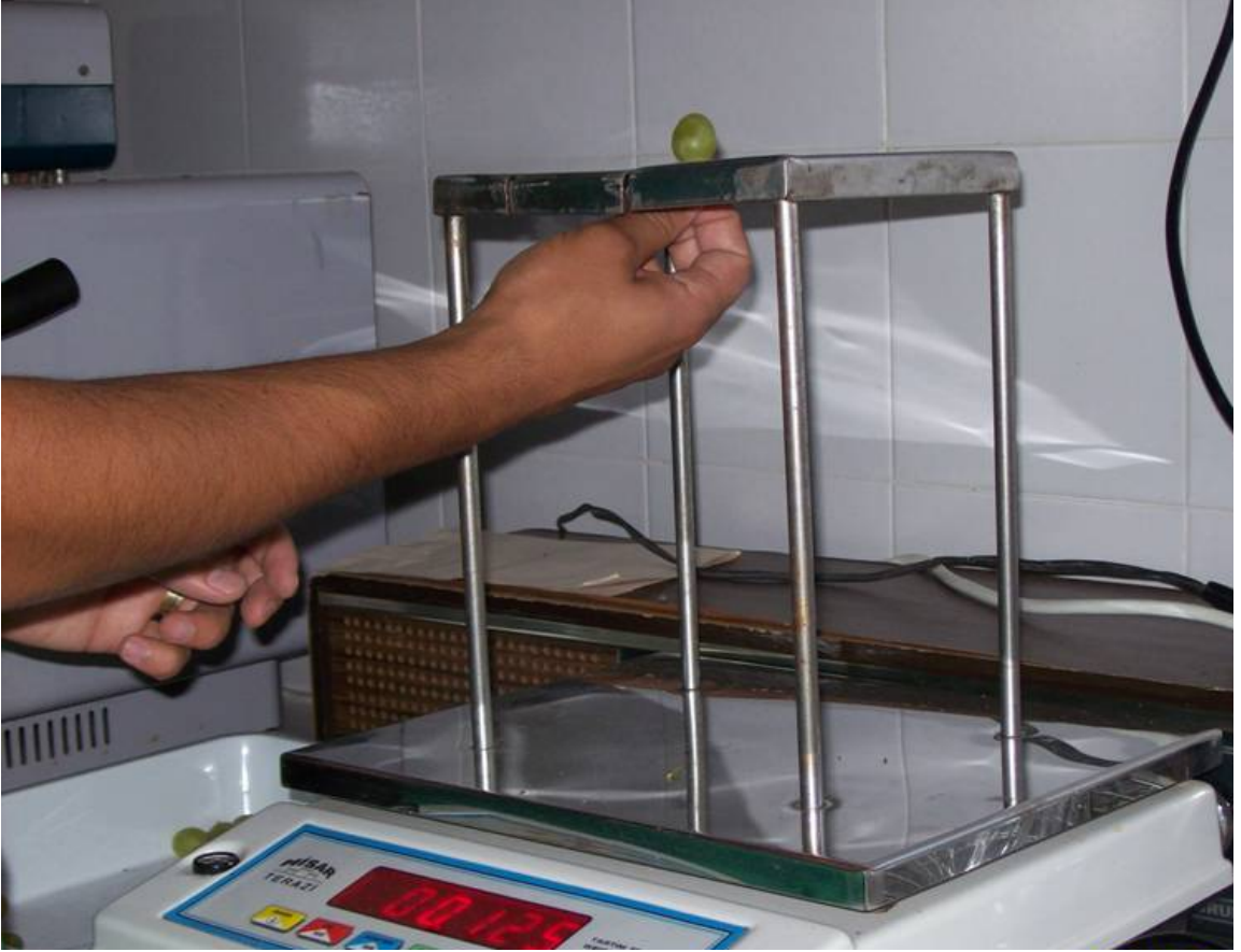
Şekil 3.4 Tanenin saptan ayrılma kuvvetinin ölçülmesi
