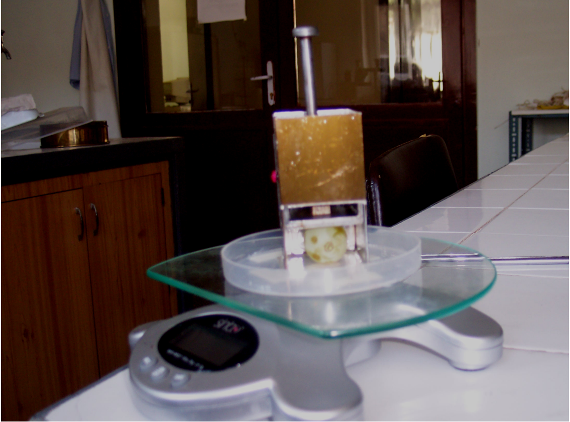
Şekil 3.2 Tane elastikiyetinin ölçüldüğü düzenek
