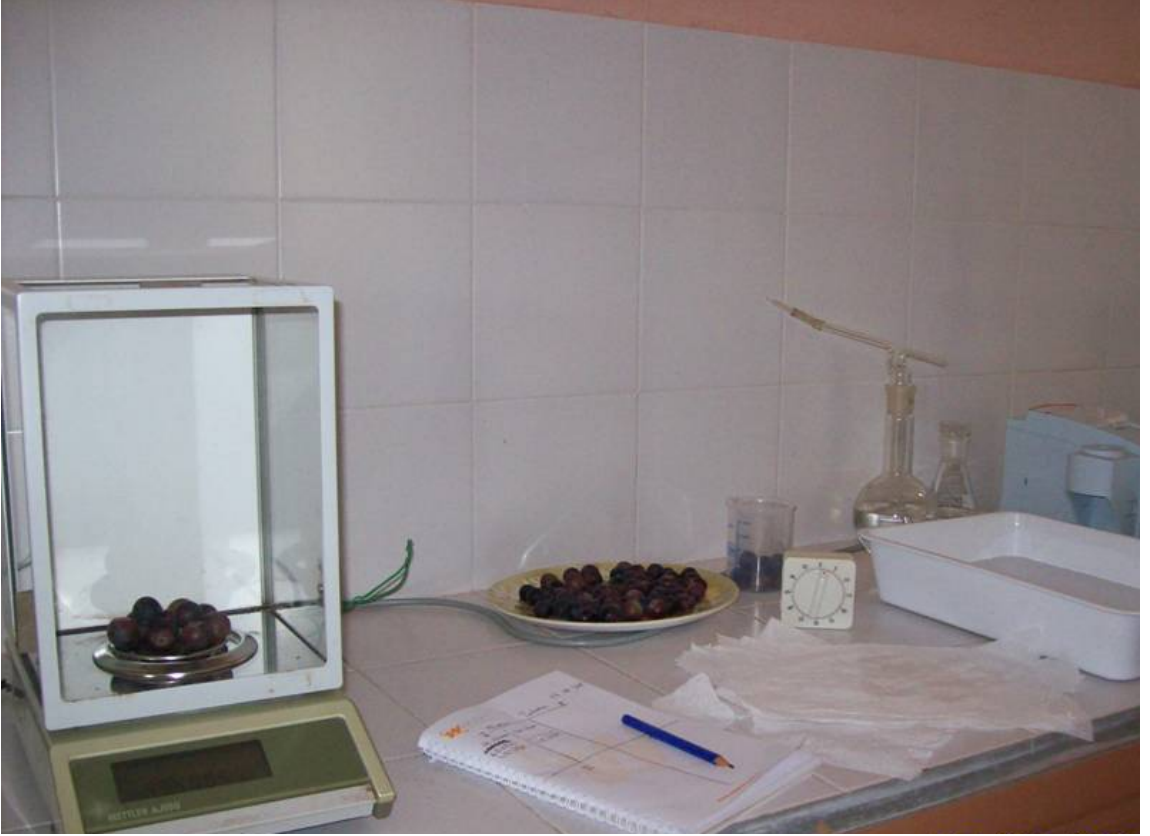
Şekil 3.1 Tanelerin 100 tane ağırlıklarının saptandığı terazi
