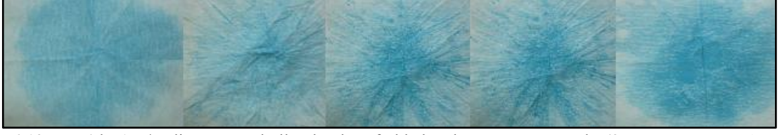
Şekil 6.12. pH7'de 1 g/L dispergatör kullanılarak 5 farklı bm konsantrasyonunda (2-4-6-8-10 g/L) ultrasonlu ortamda hazırlanmış bakır monokarboksilat çözeltilerine ait filtre kağıtlarının görüntüleri
