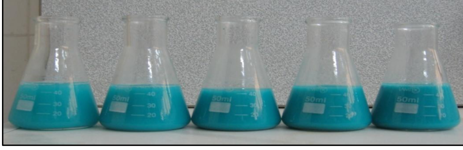
Şekil 6.6. pH 7’de 1 g/L dispergator kullanılarak 5 farklı bm konsantrasyonunda (2-4-6-8-10 g/L) ultrasonlu ortamda hazırlanmış bakırmonokarboksilat çözeltilerine ait görüntüler
