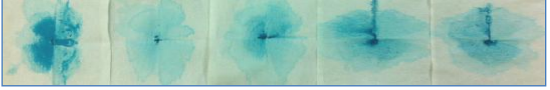
Şekil 6.37. pH7’de 6 g/L bm kullanılarak 5 farklı dispergatör konsantrasyonunda (0.5-1-1.5-2-2.5 g/L) ultrasonlu ortamda hazırlanmış bakır dikarboksilat çözeltilerine ait filtre kağıtlarının görüntüleri
