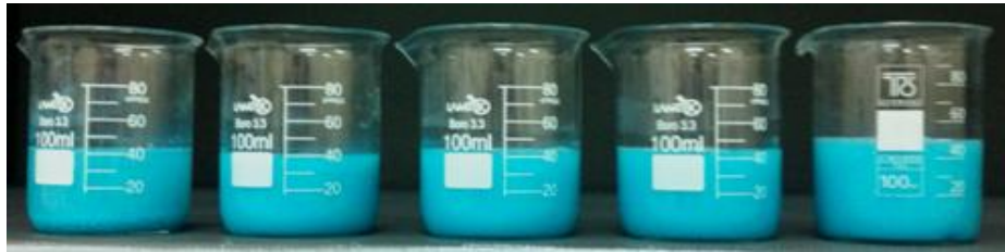
Şekil 6.31. pH 7'de 6 g/L bm kullanılarak 5 farklı dispergatör konsantrasyonunda (0.5-1-1.5-2-2.5 g/L) ultrasonlu ortamda hazırlanmış bakır dikarboksilat çözeltilerine ait görüntüler
