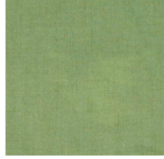
Şekil 6.43. pH 7'de 2 g/L Bakır monokarboksilat+1 g/L Dispergator+1 g/L egalizatör ile Boyanmış Yün Kumaşın Görüntüsü
