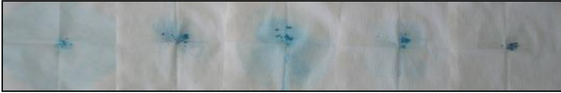
Şekil 6.25. 6 g/L bm ve 1 g/L dispergatör kullanılarak 5 farklı pH'ta (1-4-7-10-13) ultrasonlu ortamda hazırlanmış bakır dikarboksilat çözeltilerine ait filtre kağıtlarının görüntüleri
