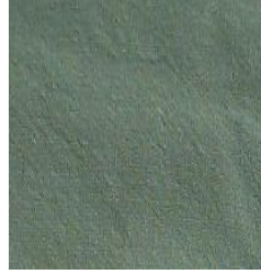
Şekil 6.44. pH 7'de 6 g/L Bakır dikarboksilat+1 g/L Dispergator+1 g/L egalizatör ile Boyanmış Yün Kumaşın Görüntüsü
