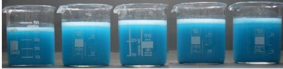
Şekil 6.30 pH 7'de 6 g/L bm kullanılarak 5 farklı dispergatör konsantrasyonunda (0.5-1-1.5-2-2.5 g/L) ultrasonlu ortamda hazırlanmış bakır monokarboksilat çözeltilerine ait görüntüler
