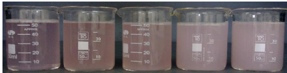
Şekil 6.32. pH 7'de 6 g/L bm kullanılarak 5 farklı dispergatör konsantrasyonunda (0.5-1-1.5-2-2.5 g/L) ultrasonlu ortamda hazırlanmış kobalt monokarboksilat çözeltilerine ait görüntüler
