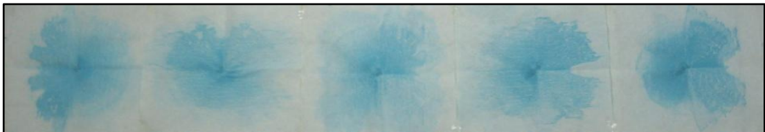
Şekil 6.36. pH7’de 6 g/L bm kullanılarak 5 farklı dispergatör konsantrasyonunda (0.5-1-1.5-2-2.5 g/L) ultrasonlu ortamda hazırlanmış bakır monokarboksilat çözeltilerine ait filtre kağıtlarının görüntüleri
