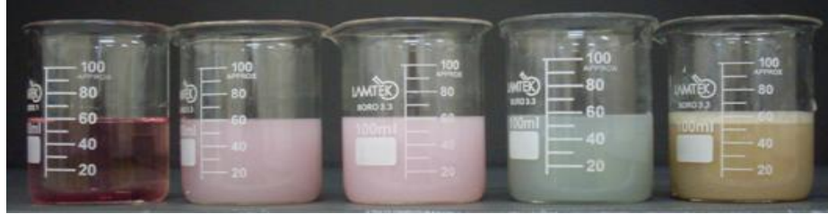
Şekil 6.21. 6 g/L bm ve 1 g/L dispergator kullanılarak 5 farklı pH'ta (pH 1-4-7-10-13) ultrasonlu ortamda hazırlanmış kobalt dikarboksilatçözeltilerine ait görüntüler
