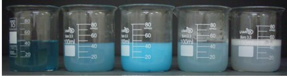
Şekil 6.19. 6 g/L bm ve 1 g/L dispergator kullanılarak 5 farklı pH'ta (pH 1-4-7-10-13) ultrasonlu ortamda hazırlanmış bakır dikarboksilatçözeltilerine ait görüntüler
