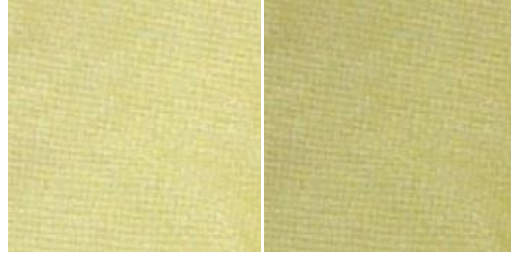
Şekil 6.46. pH 7’de 10 g/L Nikel monokarboksilat ve dikarboksilat+0,5 g/L Dispergator+1 g/L egalizatör ile Boyanmış Yün Kumaşın Görüntüsü
