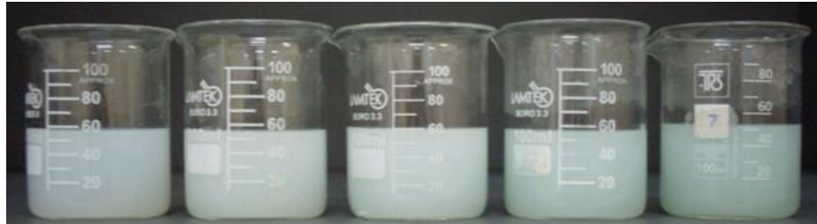
Şekil 6.35. pH 7’de 6 g/L bm kullanılarak 5 farklı dispergatör konsantrasyonunda (0.5-1-1.5-2-2.5 g/L) ultrasonlu ortamda hazırlanmış nikel dikarboksilat çözeltilerine ait görüntüler
