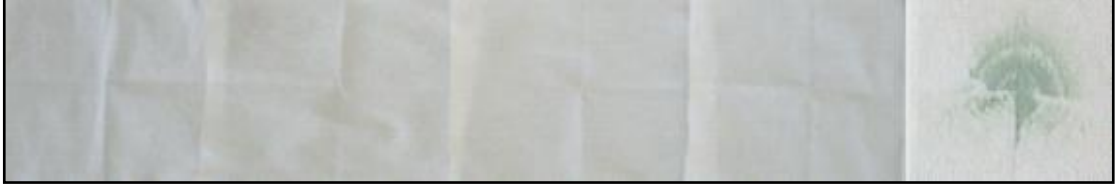
Şekil 6.28. 6 g/L bm ve 1 g/L dispergator kullanılarak 5 farklı pH'ta (1-4-7-10-13) ultrasonlu ortamda hazırlanmış nikel monokarboksilatçözeltilerine ait filtre kağıtlarının görüntüleri
