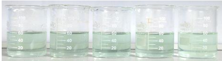
Şekil 6.34. pH 7’de 6 g/L bm kullanılarak 5 farklı dispergatör konsantrasyonunda (0.5-1-1.5-2-2.5 g/L) ultrasonlu ortamda hazırlanmış nikel monokarboksilat çözeltilerine ait görüntüler
