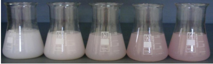
Şekil 6.8. pH 7’de 1 g/L dispergator kullanılarak 5 farklı bm konsantrasyonunda (2-4-6-8-10 g/L) ultrasonlu ortamda hazırlanmış kobalt monokarboksilat çözeltilerine ait görüntüler
