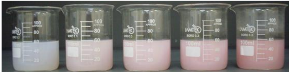
Şekil 6.9. pH 7’de 1 g/L dispergator kullanılarak 5 farklı bm konsantrasyonunda (2-4-6-8-10 g/L) ultrasonlu ortamda hazırlanmış kobalt dikarboksilat çözeltilerine ait görüntüler
