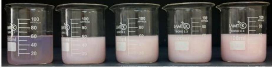
Şekil 6.33. pH 7’de 6 g/L bm kullanılarak 5 farklı dispergatör konsantrasyonunda (0.5-1-1.5-2-2.5 g/L) ultrasonlu ortamda hazırlanmış kobalt dikarboksilat çözeltilerine ait görüntüler
