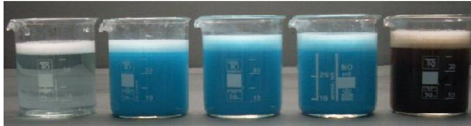
Şekil 6.18. 6 g/L bm ve 1 g/L dispergatör kullanılarak 5 farklı pH'ta (pH 1-4-7-10-13) ultrasonlu ortamda hazırlanmış bakır monokarboksilat çözeltilerine ait görüntüler
