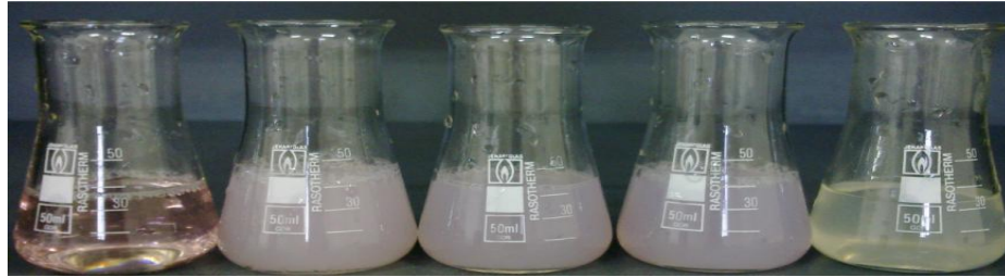
Şekil 6.20. 6 g/L bm ve 1 g/L dispergator kullanılarak 5 farklı pH'ta (pH 1-4-7-10-13) ultrasonlu ortamda hazırlanmış kobalt monokarboksilatçözeltilerine ait görüntüler
