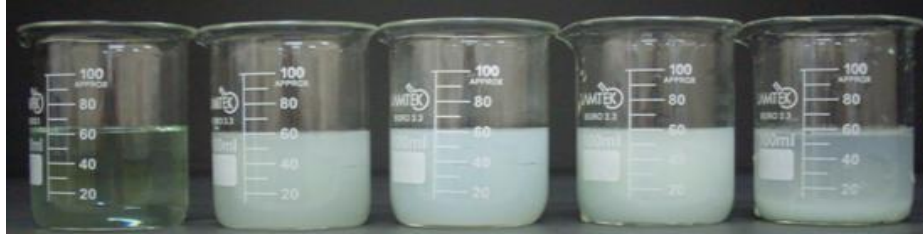
Şekil 6.23. 6 g/L bm ve 1 g/L dispergatör kullanılarak 5 farklı pH'ta (pH 1-4-7-10-13) ultrasonlu ortamda hazırlanmış nikel dikarboksilat çözeltilerine ait görüntüler
