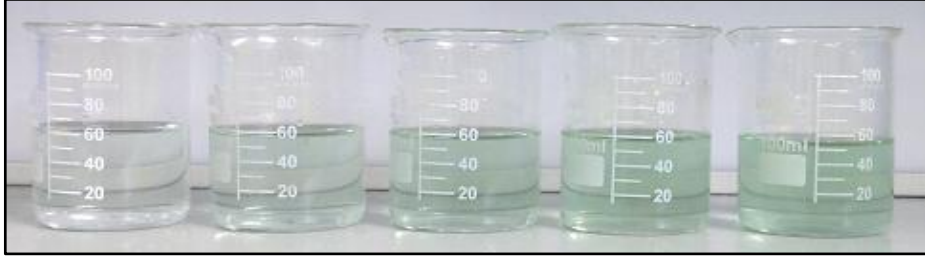
Şekil 6.10. pH 7’de 1 g/L dispergatör kullanılarak 5 farklı bm konsantrasyonunda (2-4-6-8-10 g/L) ultrasonlu ortamda hazırlanmış nikel monokarboksilat çözeltilerine ait görüntüler
