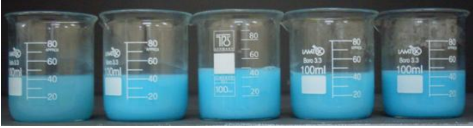
Şekil 6.7. pH 7’de 1 g/L dispergator kullanılarak 5 farklı bm konsantrasyonunda (2-4-6-8-10 g/L) ultrasonlu ortamda hazırlanmış bakır dikarboksilat çözeltilerine ait görüntüler
