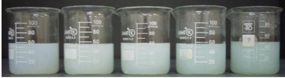
Şekil 6.11. pH 7’de 1 g/L dispergatör kullanılarak 5 farklı bm konsantrasyonunda (2-4-6-8-10 g/L) ultrasonlu ortamda hazırlanmış nikel dikarboksilat çözeltilerine ait görüntüler
