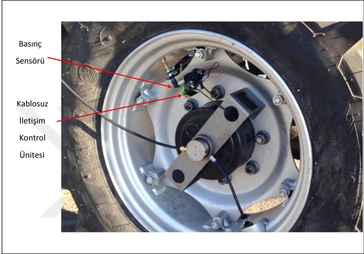
Şekil 4.19. Basınç sensörü ve iletişim kontrol ünitesinin yerleşimi
