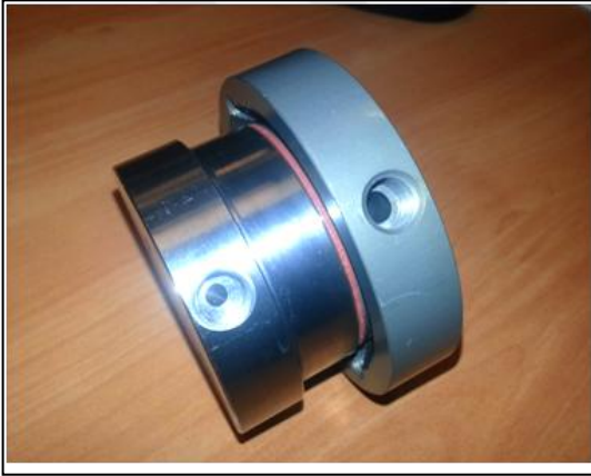
Şekil 4.6. İmal edilen tekerlek valfi
