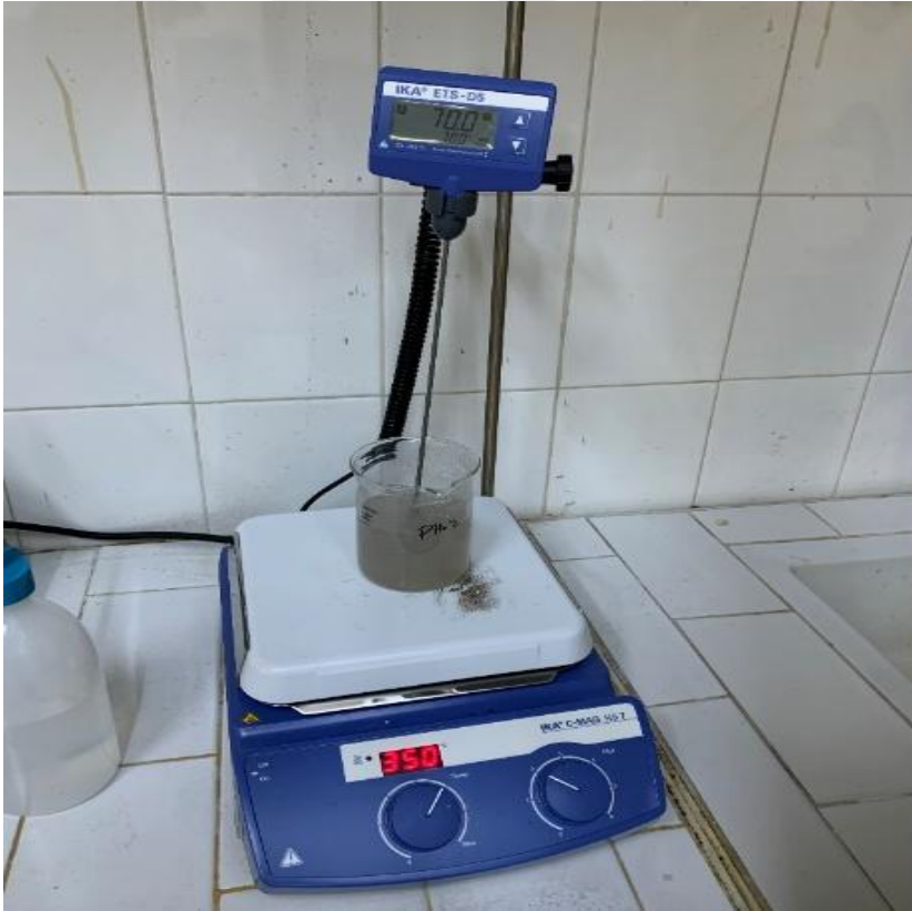
Şekil 3.1. Sıcaklık/PS oksidasyon düzeneği
