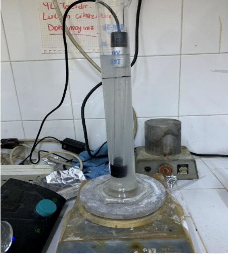
Şekil 3.2. UV/PS ve UV/PMS oksidasyon düzeneği
