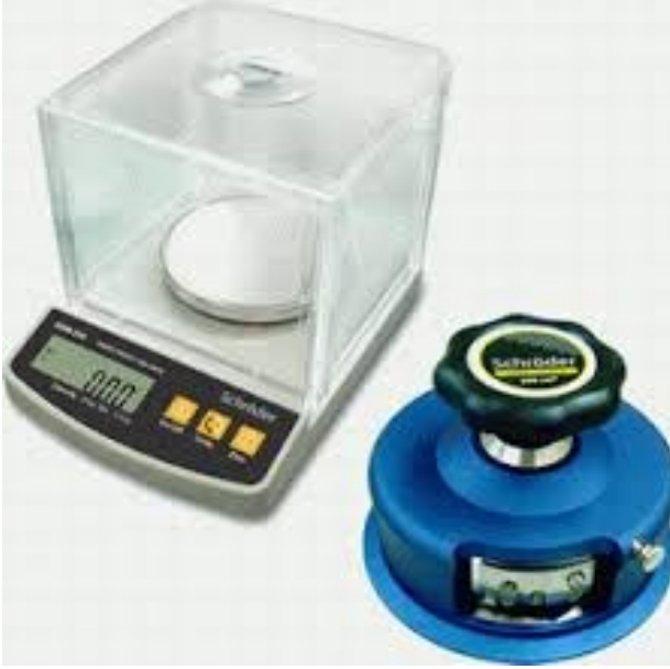
Şekil 4.4. Gramaj numune alma aparatı ve hassas terazi
