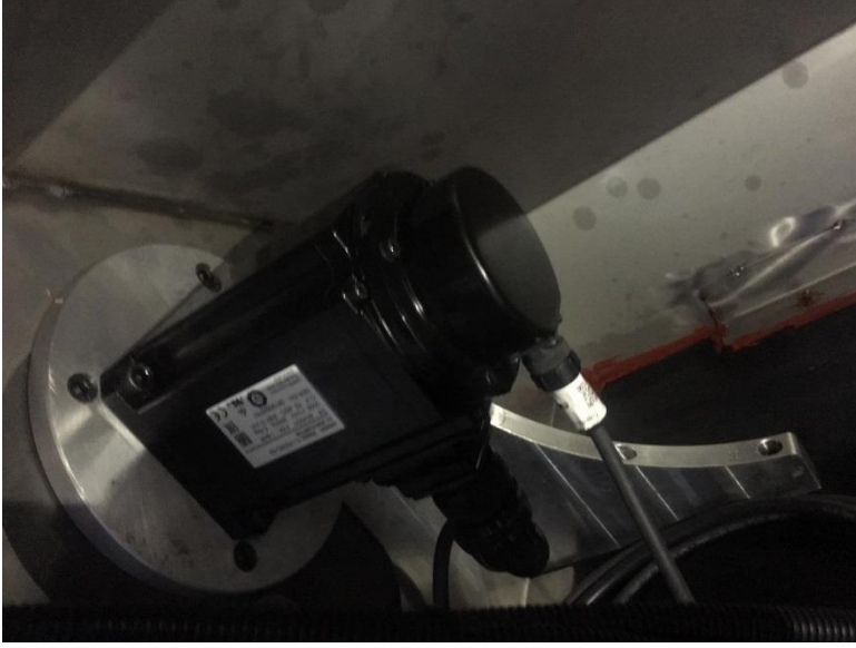
Şekil 3-5. Kesme diski tahrik motoru ve bağlantısı
