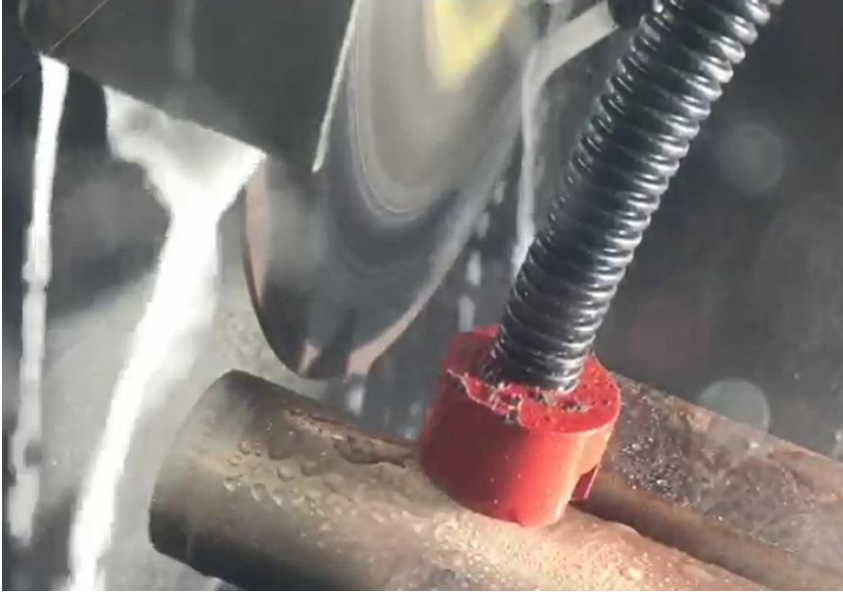
Şekil 3-29. Kesme diskinin soğutma sıvısı ile soğutulması
