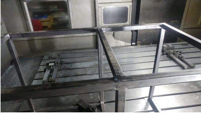
Şekil 3-25. Cnc freze tezgahında şasenin işlenmesi
