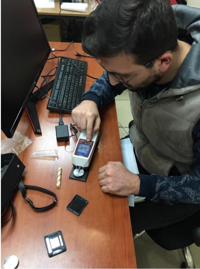
Şekil 3-30. Yüzey pürüzlülük değerinin ölçülmesi
