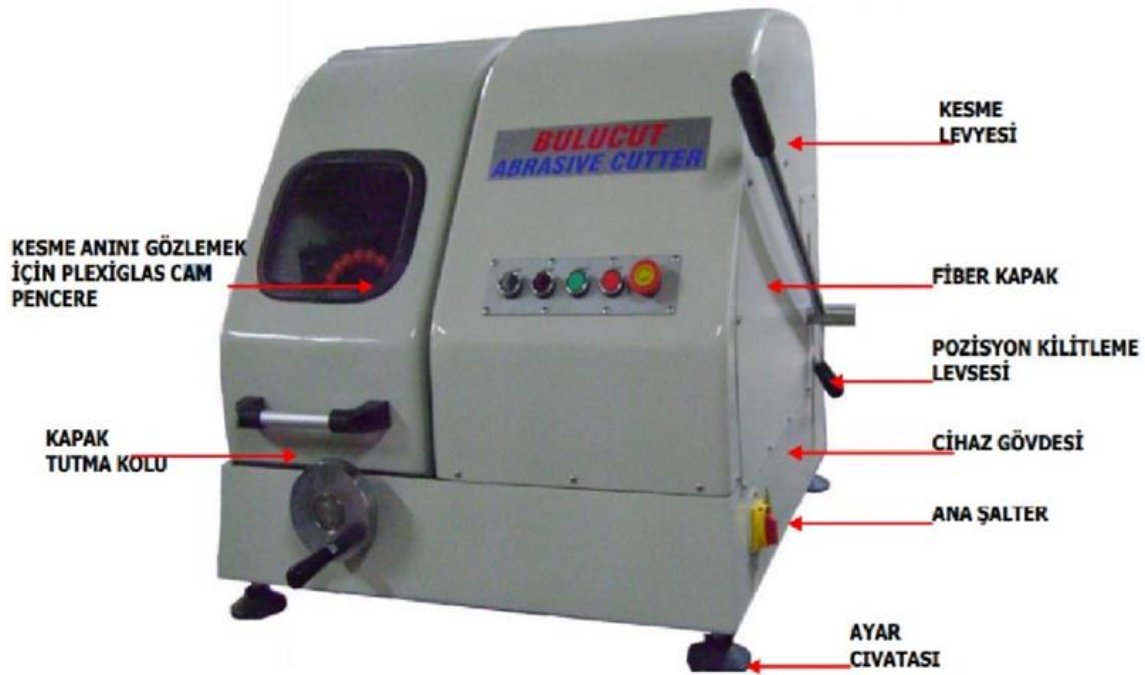
Şekil 1-5. Hareketli diskli numune kesme makinası genel görünümü (Bulut, 2018)
