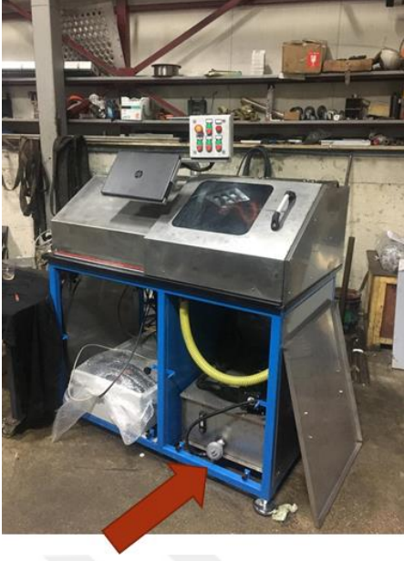
Şekil 3-22. Kabin sıcaklık ölçüm sensörü
