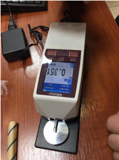
Şekil 3-23. SJ-210 portatif yüzey pürüzlülük ölçme cihazı
