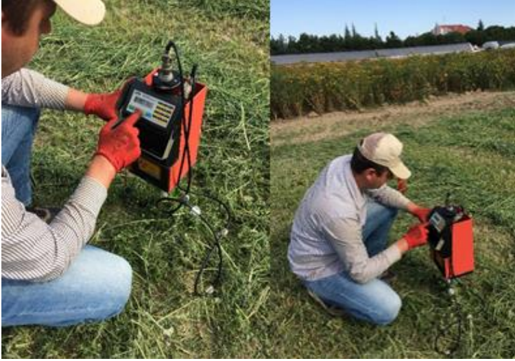
Şekil 3.4 Araştırma alanında nötronmetre ile nem ölçümü
