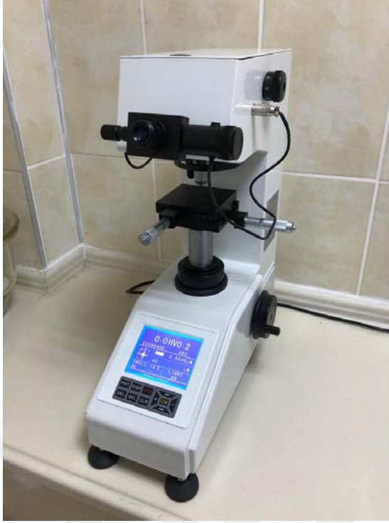
Şekil 3.9. MICROBUL 1000-DN Micro Vickers sertlik ölçme cihazı
