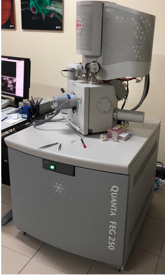
Şekil 3.8. Quanta FEG 250 marka SEM cihazı
