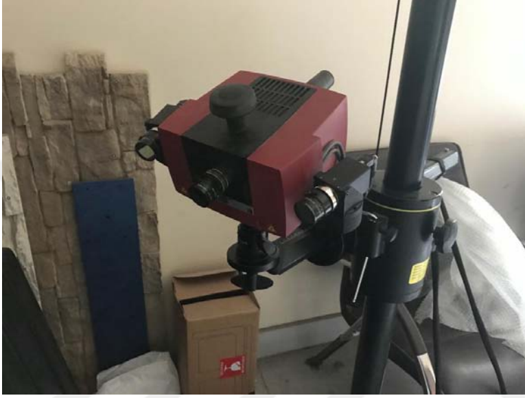
Şekil 3.16. GOM marka Atos Compact model 3D tarama cihazı
