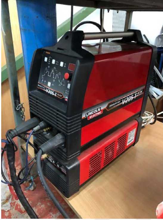
Şekil 3.3. Lincoln Invertec® V205-T AC/DC kaynak makinesi
