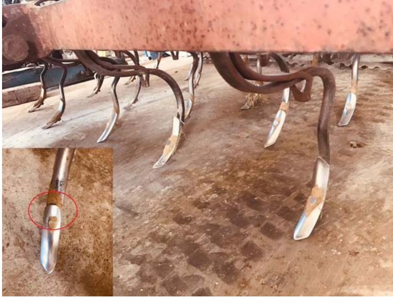
Şekil 3.12. Kültivatör uç demirlerinde meydana gelen aşınma
