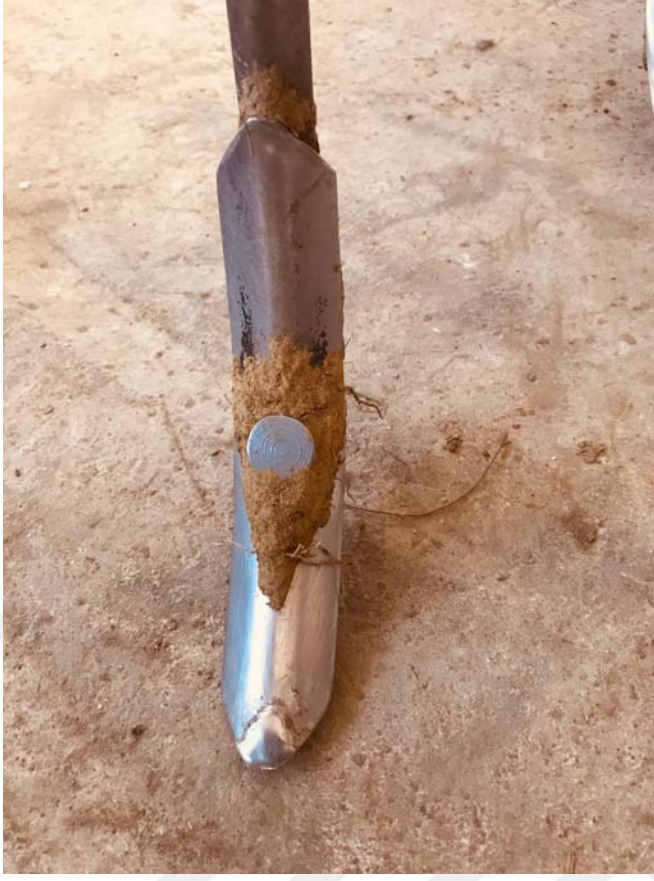
Şekil 4.24. Tarla denemeleri sonucu aşınan kùltivatör uç demiri
