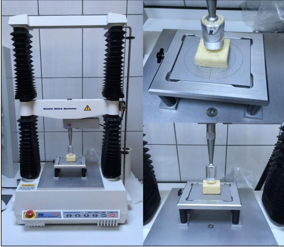
Şekil 3.21. Kek örneklerinin tekstür analizi
