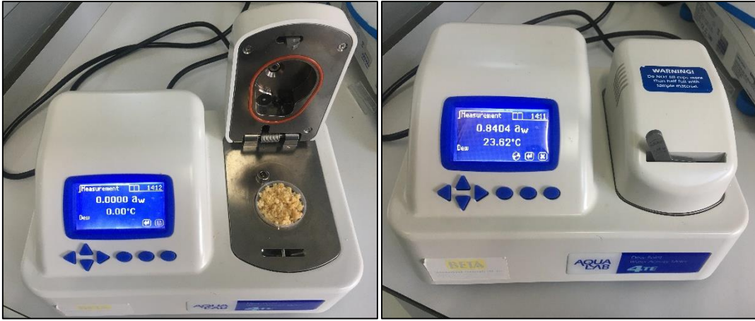
Şekil 3.16. Örneklerin su aktivitesi değerleri ölçümü
