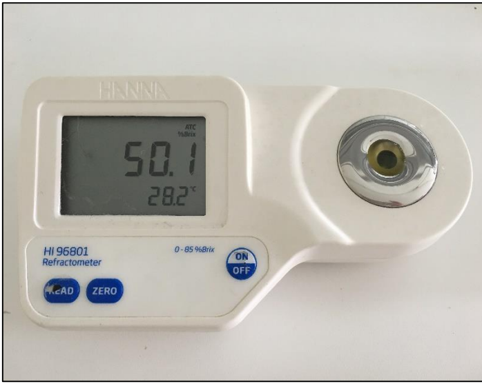
Şekil 3.1. Şeker karışımlarının Briks derecelerinin ölçülmesi
