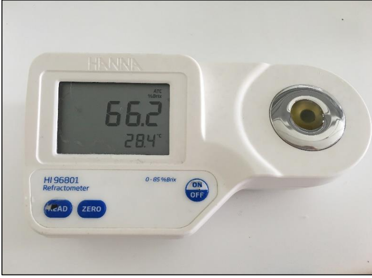
Şekil 3.5. Şeker karışımlarının briks derecelerinin ölçülmesi
