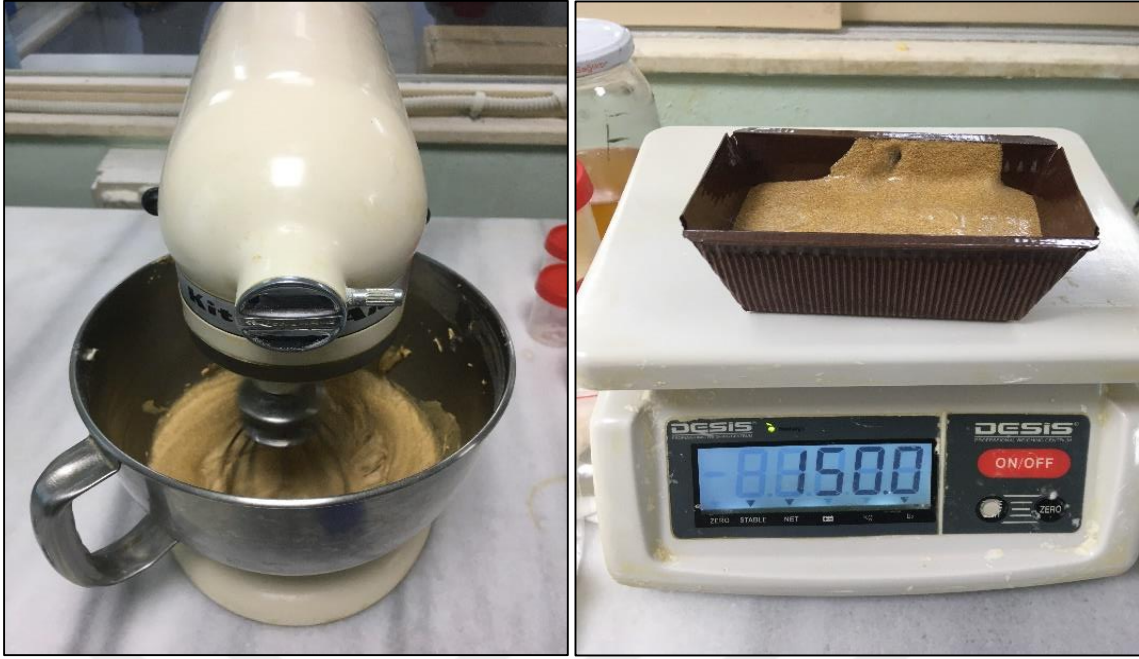
Şekil 3.2. Kek bileşenlerin mikserde karıştırılması ve tartımı
