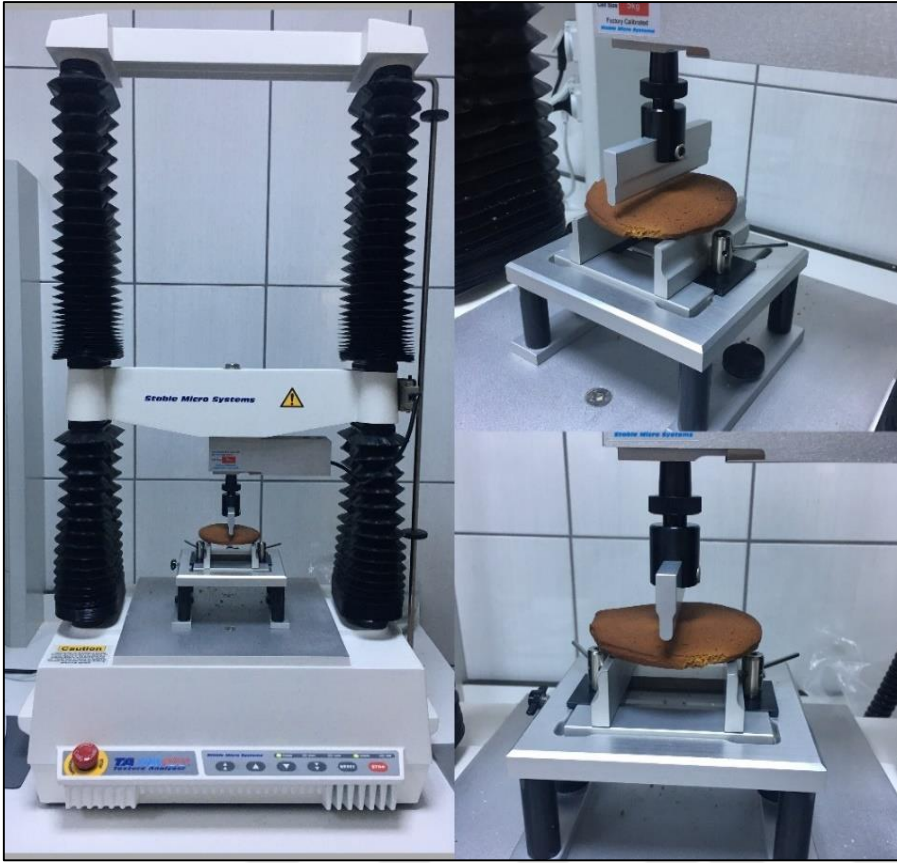
Şekil 3.22. Kurabiye örneklerinin tekstür analizi
