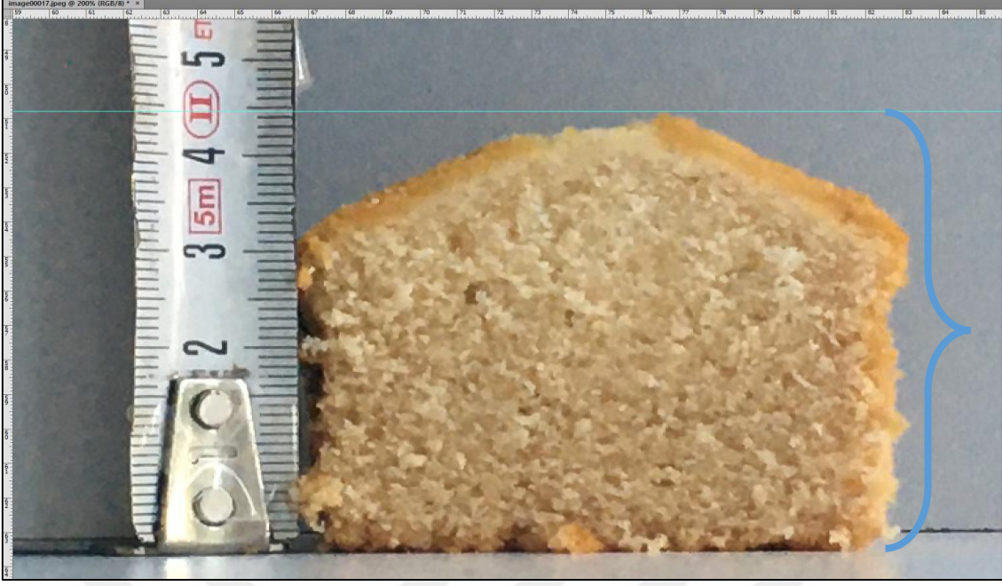
Şekil 3.12. Kek örneklerinin izdüşüm çizgisi indirilerek kabarma indeksi ölçümü yapılması
