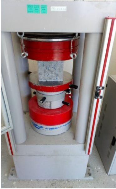
Şekil 3.15. Örnekler üzerinde uygulanan basınç dayanımı deneyi
