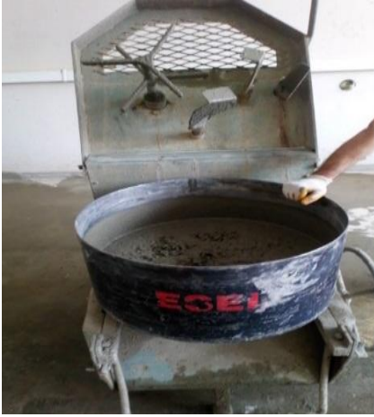
Şekil 3.8. Araştırmada kullanılan laboratuvar tipi beton mikseri
