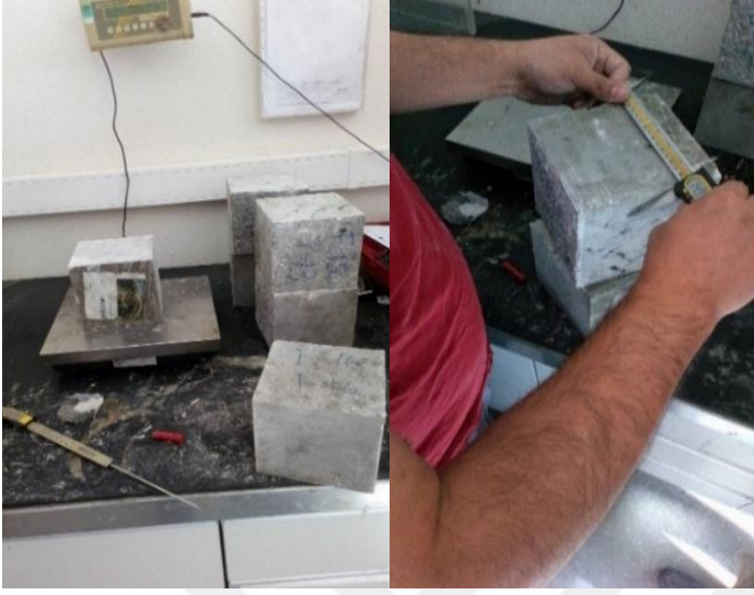
Şekil 3.13. Sertleşmiş beton birim ağırlık deneyi
