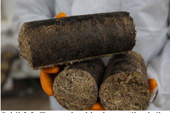
Şekil 2.2. Tarımsal atıklardan üretilen briket
