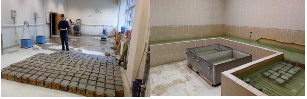
Şekil 3.11. Beton örneklerinin dökümü ve kür
