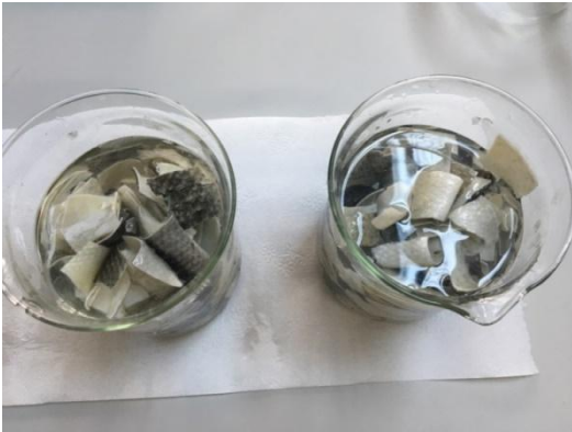
Şekil 4.3. Balık derilerinin sodyum klorür ile muamelesi
