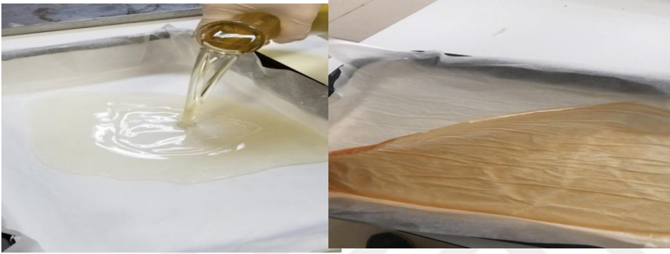
Şekil 4.5. Jelatinin filtrasyon sonrasında etüvde kurutulması ve kurutma sonrası görünümü
