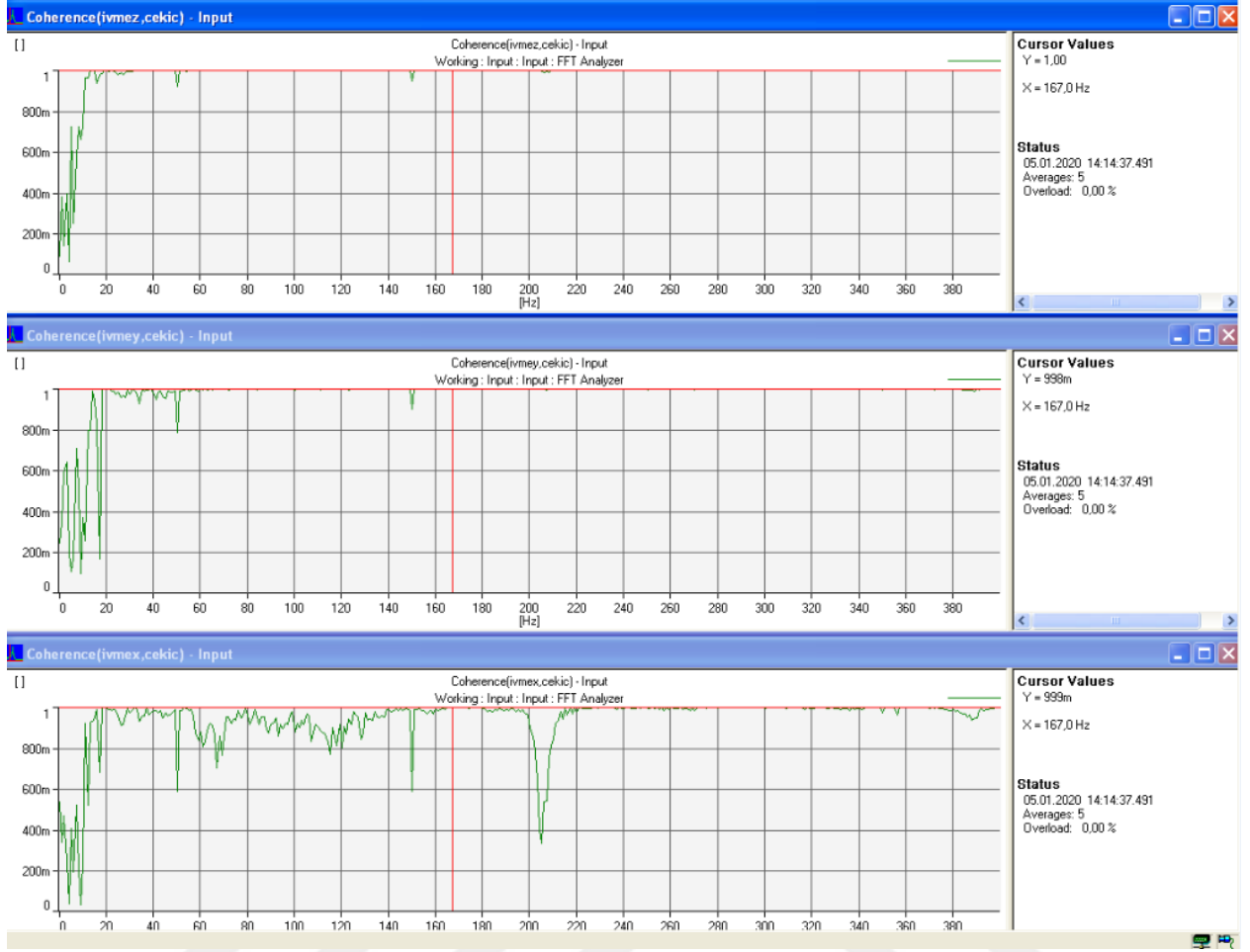
Şekil 4.33 Çekiç darbe testi uygunluk ölçümü
