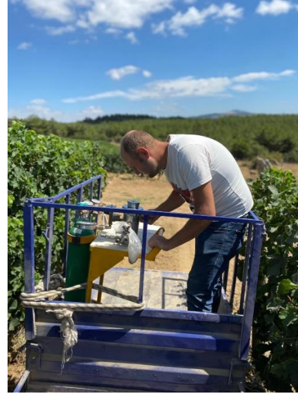
Şekil 3.6. Şafak öncesi ve gün ortası Yaprak Su Potansiyeli ölçümleri (Koskosoğlu Batuhan 2020 Orijinal Fotoğraf)
