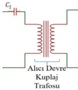
Şekil 3.6. PLC Alıcı Devresi İzolasyon Transformatorünün şebeke tarafındaki C_1 kondansatöründen oluşan Kuplaj devresi
