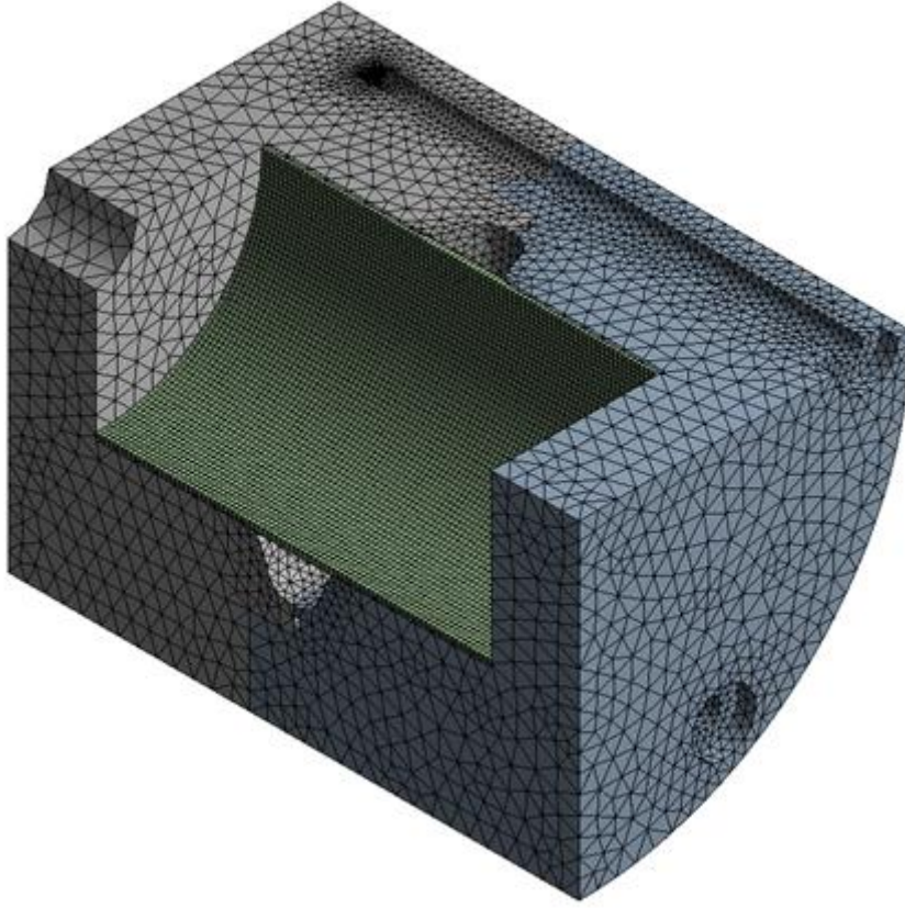
Şekil 3. 12. Hidrolik şişirme ünitesi sonlu elemanlar modeli
