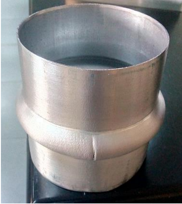
Şekil 2. 7. Tüp hidrolik şekillendirme uygulamalarında yırtılma hata türü
