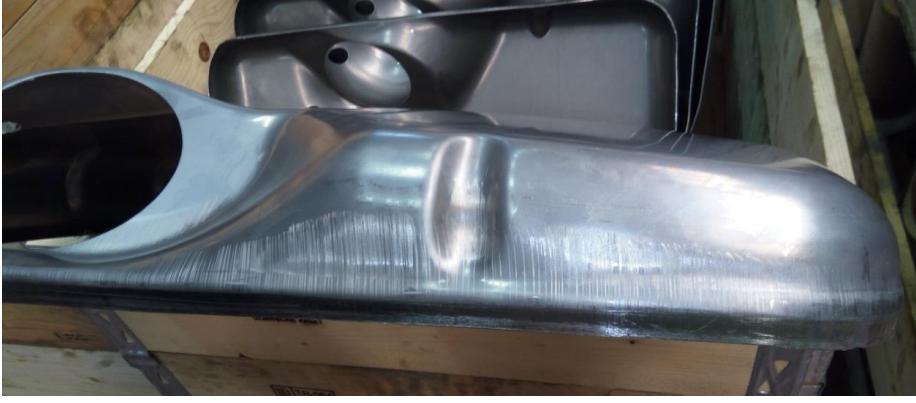
Şekil 1.1. Derin çekme işleminde oluşan çizikler
