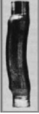
Şekil 2. 5. Tüp hidrolik şekillendirme uygulamalarında burkulma hata türü [31].
