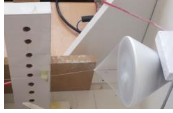
Şekil 4.6. Kılavuz ilave edilmiş prototip sistemde iplik eğirme
