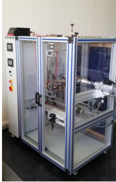
Şekil 5.8. PLC kontrollü nanolif iplik eğirme makinesi
