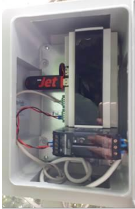
Şekil 3.26. RP-0101 Kontrol ve ağ geçidi modülü (19.03.2018)
