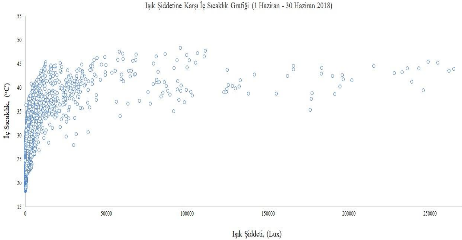
Şekil 4.b.5. İç Sıcaklık – Işık Şiddeti(LUX - ° C) grafiği ( 1 Haziran – 30 Haziran 2018)
