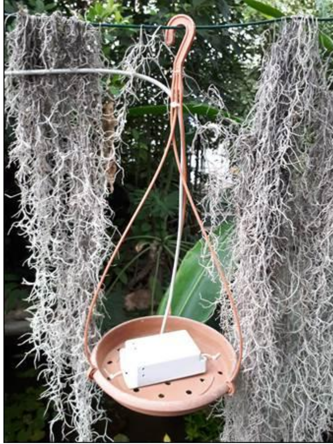
Şekil 3.28. 0x01410109-TH-0141- Botanik iç sensörü ve modülü (19.03.2018)
