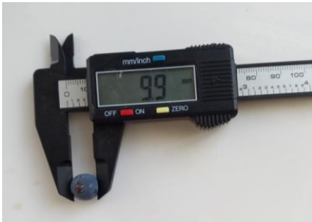
Şekil 3.9. Dijital kumpasla tane eni ölçümü
