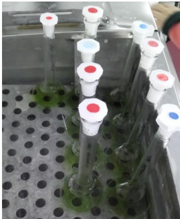
Şekil 3.11. Toplam fenolik madde miktarı tayini için 75°C’lik su havuzunda bekletilen çözeltiler
