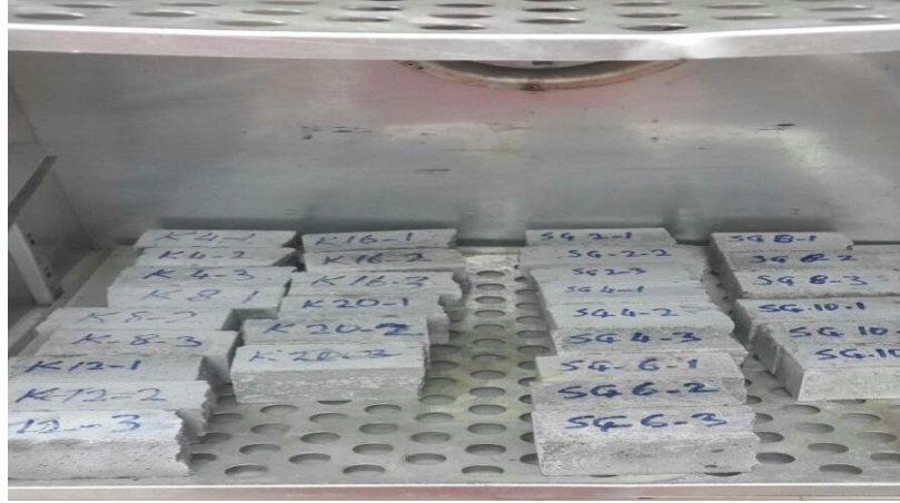
Şekil 4.8. Su emme deneyi için etüvde numunelerin kurutulması
