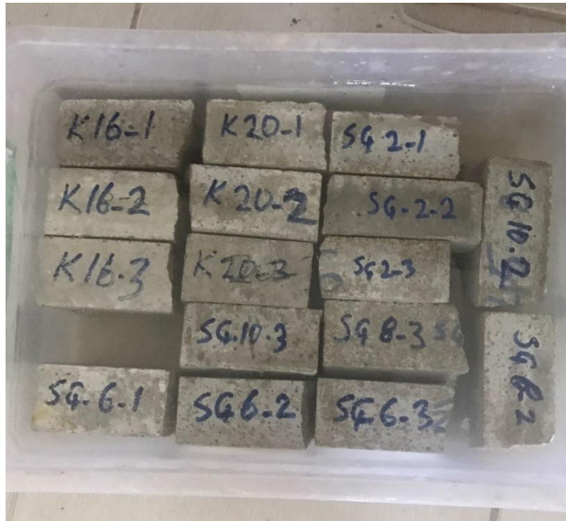
Şekil 4.3. Kürde bekletilen harç numuneleri
