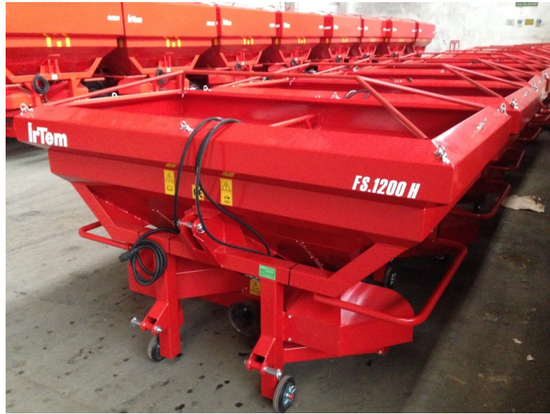
Şekil 3.41. Montaj işlemleri tamamlanmış gübre serpmeye makineleri
