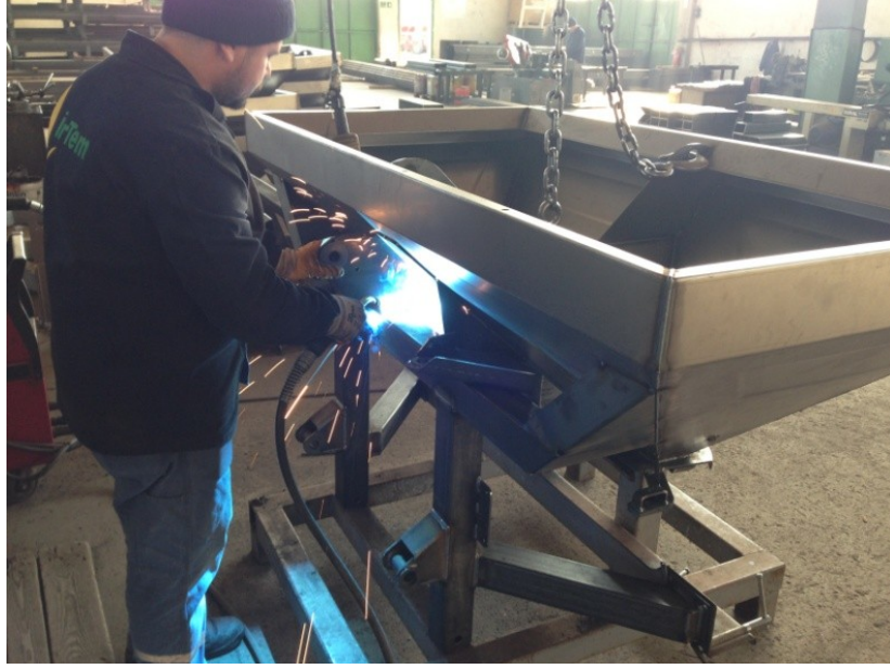
Şekil 3.32. Seri iş montaj kalıbına alınan kısımların bitirme kaynaklarının yapılması
