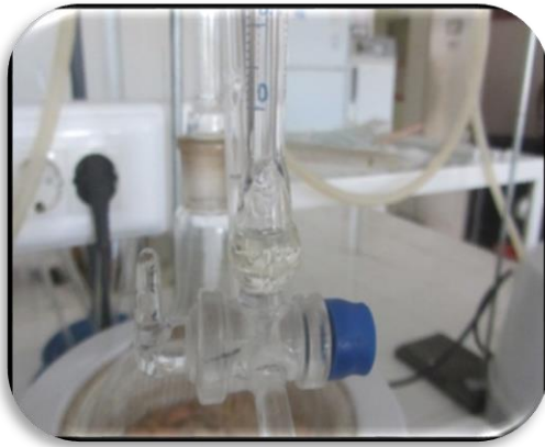
Şekil 3.6. Clevenger cihazı (titrasyon musluğu)
