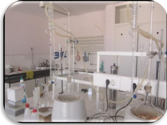
Şekil 3.7. Clevenger cihazı genel görünüm
