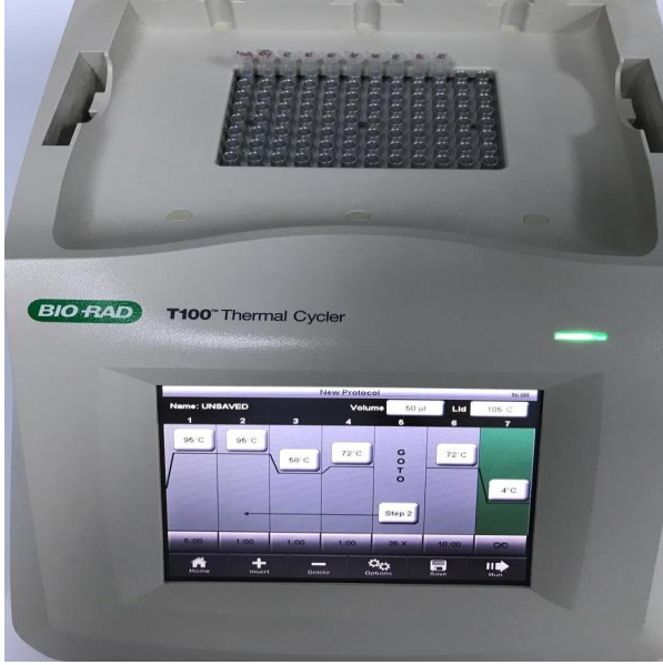
Şekil 3.9. Hazırlanan DNA örneklerinin PCR uygulaması
