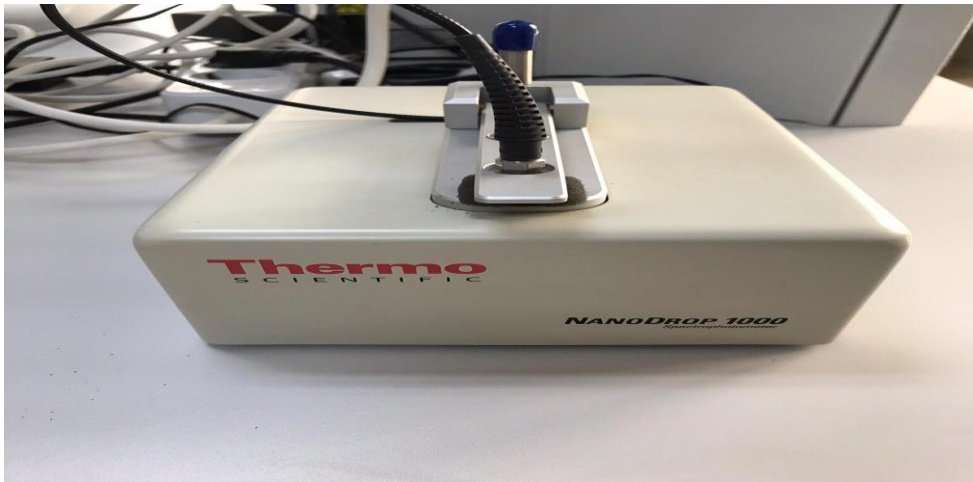
Şekil 3.8. DNA miktarının belirlenmesinde kullanılan spektrofotometre cihazı
