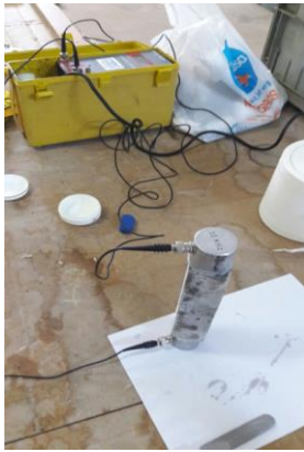
Şekil 3.4. Ultrasen geçiş hızı deneyi
