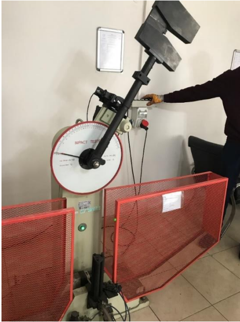
Şekil 3.27. WF10X/18 model numaralı çentik darbe deneyi cihazı
