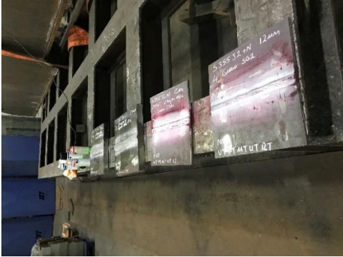
Şekil 3.15. Tahribatsız muayene yöntemleri ile kontrolü tamamlanmış numuneler.
