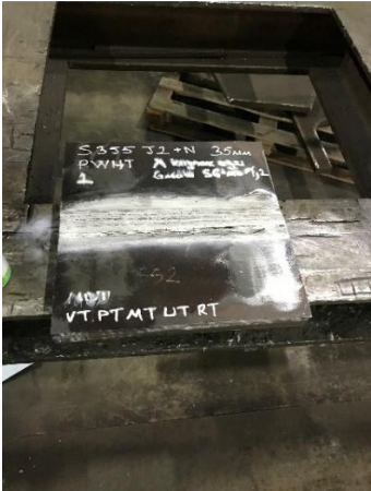
Şekil 3.7. Akım altında manyetik metal tozu uygulanmış numune
