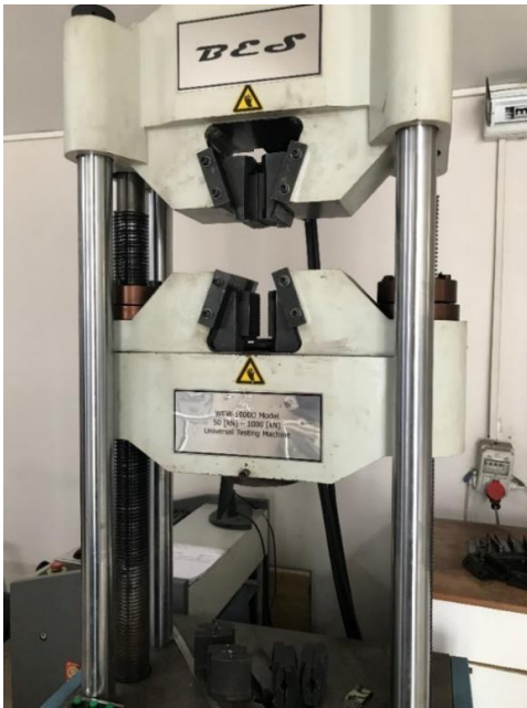
Şekil 3.20. WEW-1000D çekme- eğme testi için kullanılan cihaz
