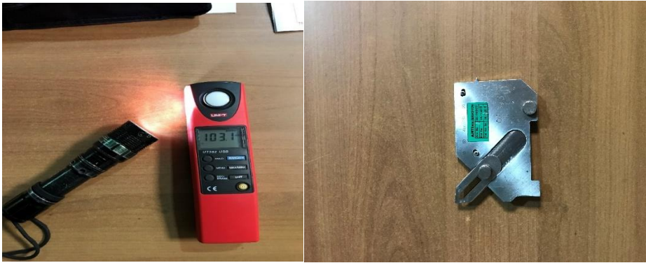
Şekil 3.4. Görsel muayene de kullanılan lüksmetre, fener, kaynak yükseklik mastarı
