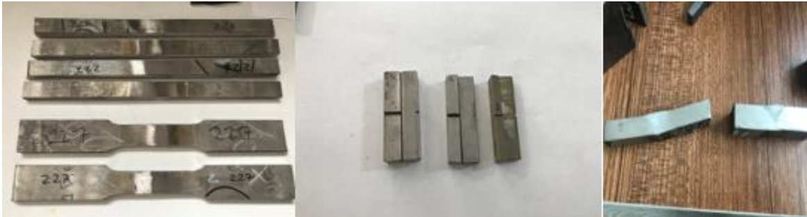
Şekil 3.17. 1'er adet 12 mm ve 35 mm kalınlığındaki numunelerden çıkarılan numuneler.
