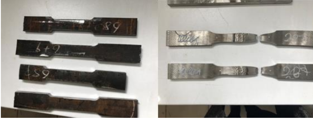
Şekil 3.19. 1 kaynaklı plakadan çıkarılan çekme deneyi numuneleri, işleme ve çekme deneyi sonrası numuneler.
