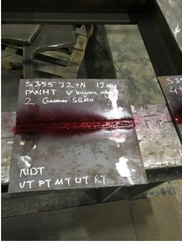
Şekil 3.9. Kırmızı pentetrant uygulaması yapılmış numune
