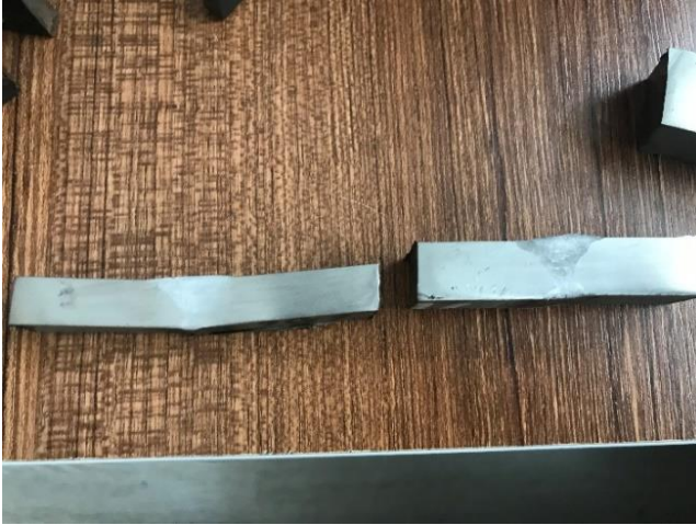
Şekil 3.30. Makroskobik ve mikroskobik dağlanan ve sertlik deneyi uygulanan numuneler
