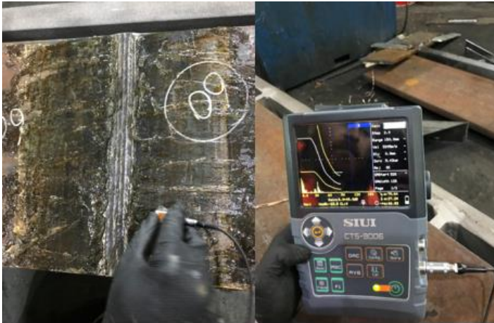
Şekil 3.11. Ultrasonik muayene uygulaması sırasında ekran görüntüsü ve anlık olarak probun konumu
