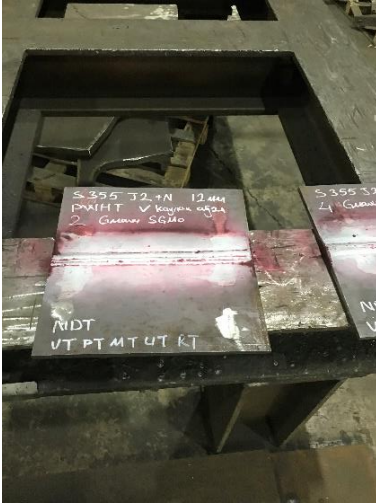
Şekil 3.10. Geliştirici sprej uygulaması yapılmış ve penetrant sıvı muayenesi tamamlanmış numune
