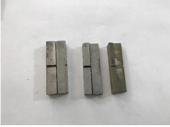
Şekil.3.26. ITAB ve kaynak bölgelerinden çıkarılan çentik darbe deneyi numuneleri
