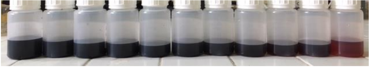
Şekil 4.13. Reactive Blue 250'nin asidik ortamda ozonlanması ile elde edilen renk giderimi görseli
