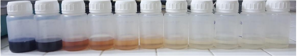
Şekil 4.29. Acid Blue 193'ün alkali ortamda ozonlanması ile elde edilen renk giderimi görseli
