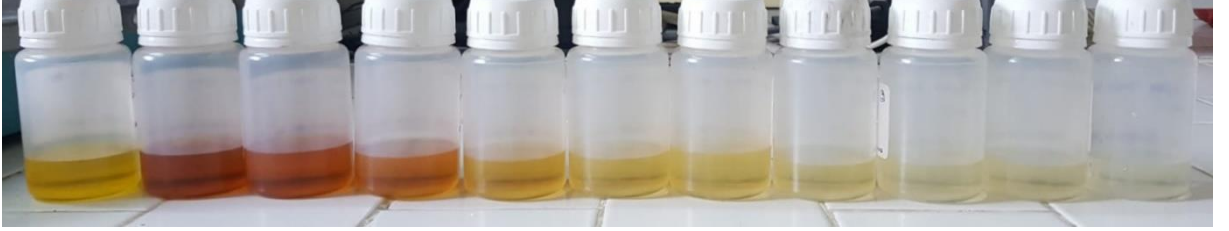
Şekil 4.24. Acid Yellow 49'un alkali ortamda ozonlanması ile elde edilen renk giderimi görseli
