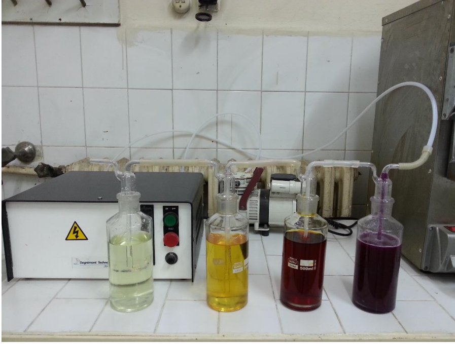
Şekil 3.2. Reaksiyon başladıktan sonra gaz yıkama şişelerinde oluşan iyot ile şeffaf çözeltilerin renginin değişmesi
