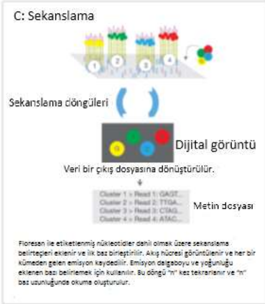
Şekil 2.2. Illumina yeni nesil sekanslama aşamaları: a-) Kütüphane oluşturma, b-) Kümelerin oluşturulması, c-) Sekanslama, d-) Hizalama ve veri analizi (Illumina, 2011)
