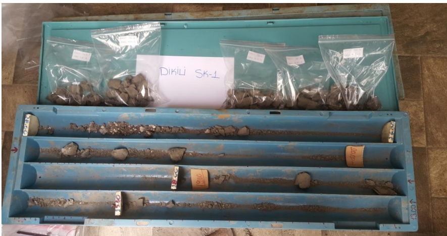
Şekil 6. 4: Dikili bölgesine ait sondaj karot örneği
