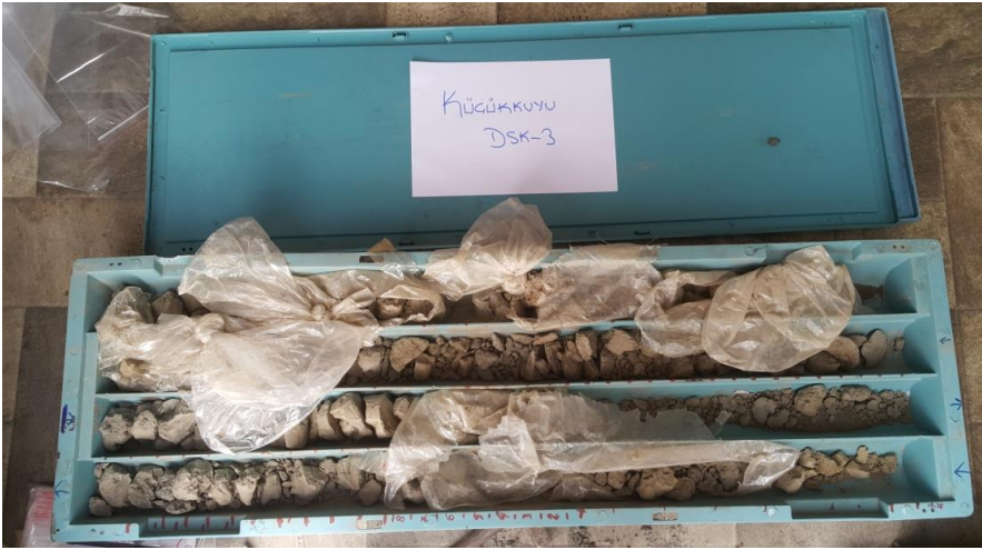
Şekil 6. 3: Küçükkuşu bölgesine ait sondaj karot örneği
